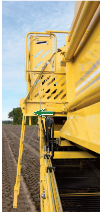
Werkplatform, 300 mm uitschuifbaar - grotere werkruimte voor meer bewegingsvrijheid
