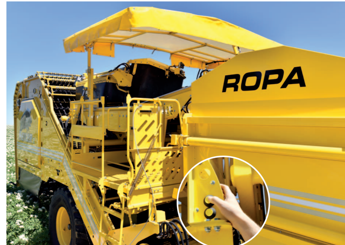
Zonnedak, in hoogte verstelbaar (optioneel, uit te breiden met zijpanelen)
