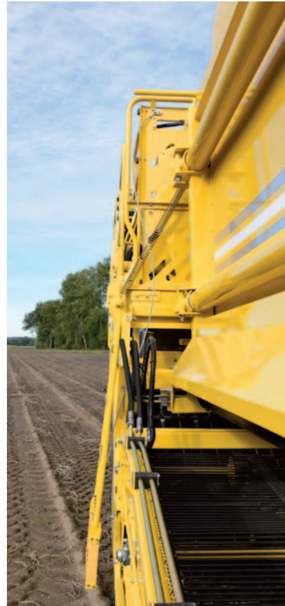
Werkplatform, 300 mm uitschuifbaar - grotere werkruimte voor meer bewegingsvrijheid
