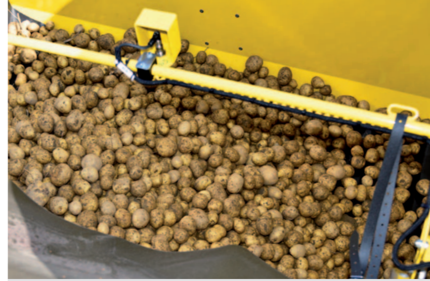
Ultrasoonsensor voor de automatische bunkervulling
