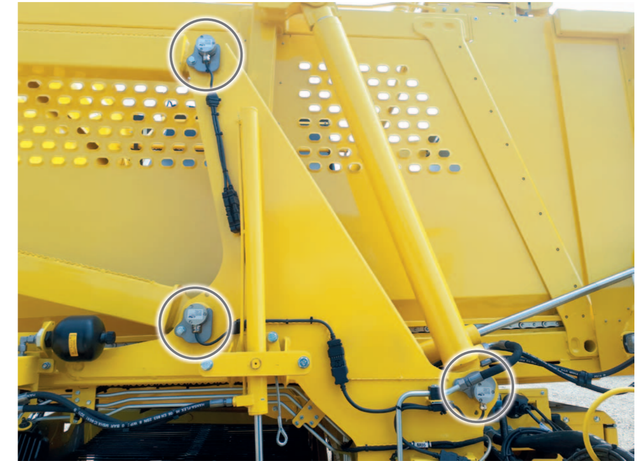
Aan de voor- en achterzijde elk 3 penkalibers
