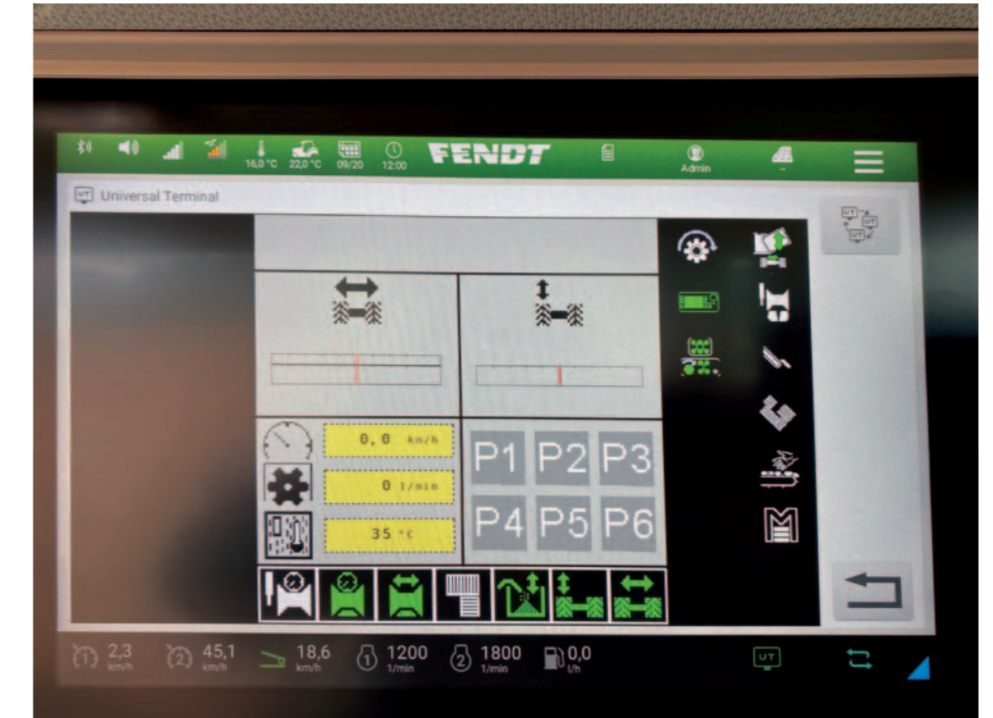
Bediening van de Keiler via de tractorterminal (Fendt One)
