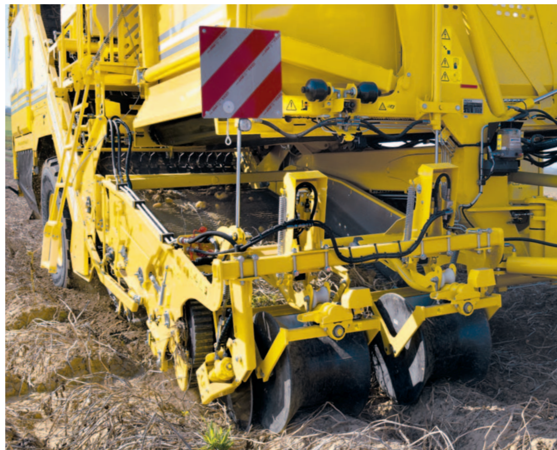
Damtrommels van kunststof, hydraulisch aangedreven schijfkouter buiten
