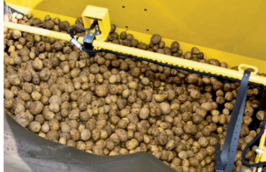
Sensore a ultrasuoni per il dispositivo automatico di riempimento del cassone
