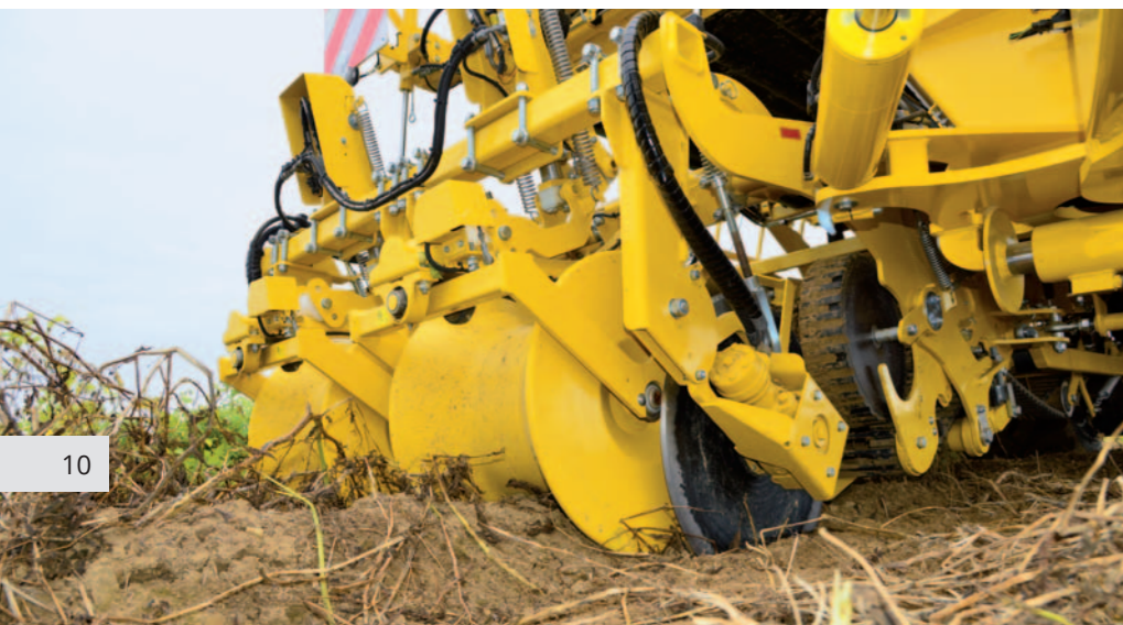
Tamburi tastatori in plastica, coltro a disco liscio azionato idraulicamente all'esterno
