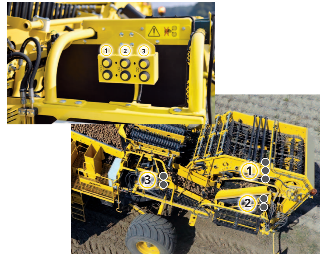
Altezza e inclinazione dei gruppi di separazione sono regolabili comodamente con un pulsante e adattabili in continuo sia idraulicamente che elettronicamente
