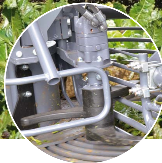
通往第二个星状过滤网的过渡连接处设有搅拌器
