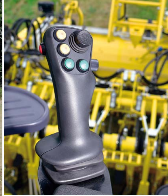
左扶手上用于灵敏控制 储料仓清空的操作元件
