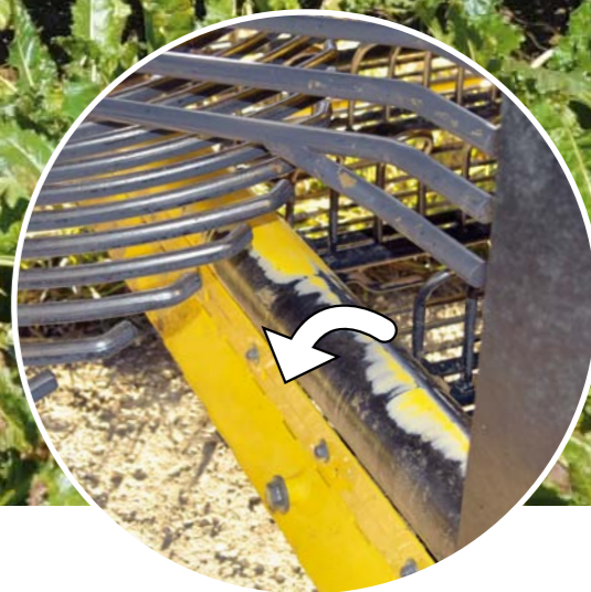
升降带入口处装有旋转过渡管，可防止土壤堆积
