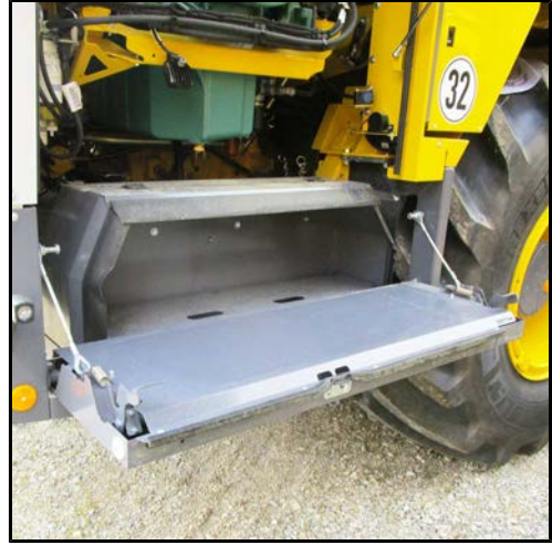
Sağ Motor yuvasında saklama gözü (sadece RT6Sa da)
