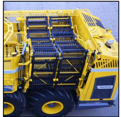
Nakliye konumunda boşaltma bandı büküm parçası 1 ve 2
