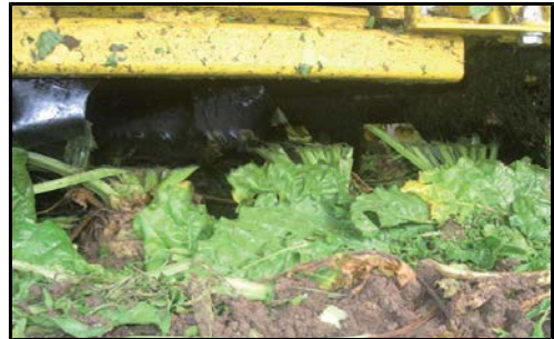
Ön hazırlayıcı yüksekliği ideal hazırlandı
