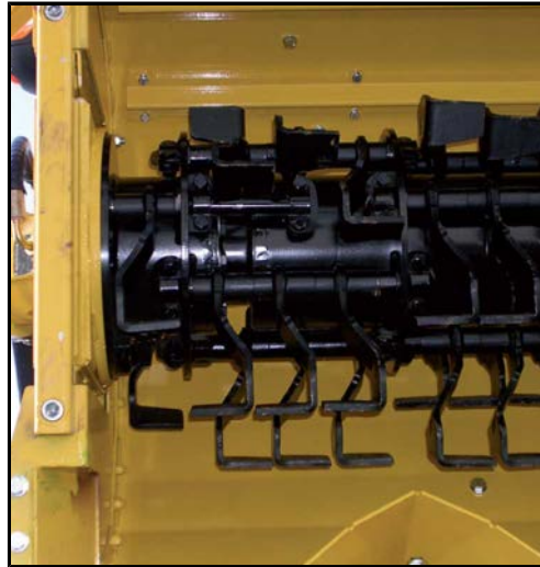
RIS'de Ön hazırlayıcı bıçaklar ve kelepçe sekmeleri
