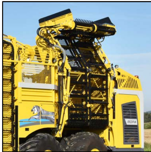
Mahsul çıkarma konumunda boşaltma bandı büküm parçası 1 ve 2
