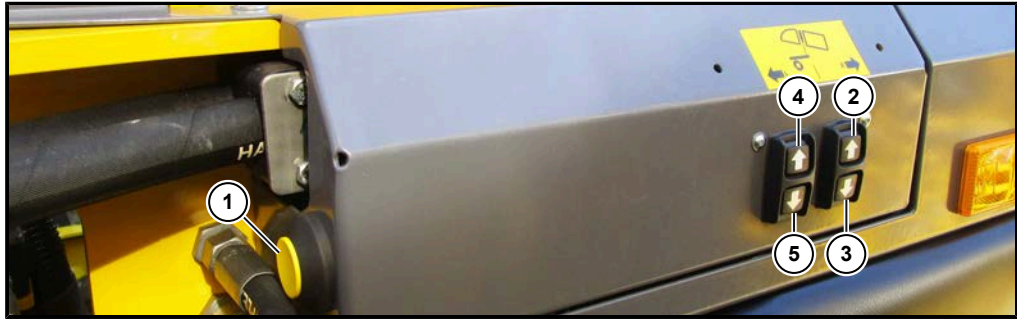
Sağ söküm takımı zemin tuş takımı
