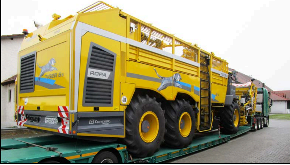
شاحنة بسطح تحميل منخفض عادي للنقل على الطريق مع ارتفاع النقل الأدنى
