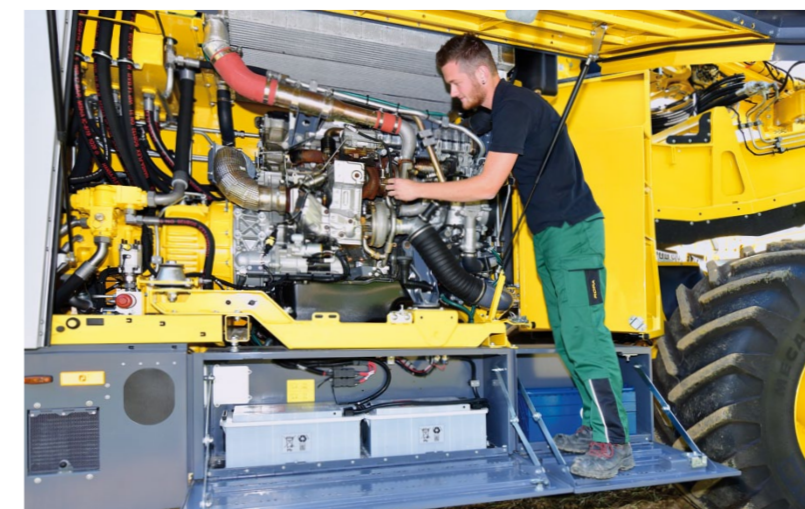
Двигатель Mercedes-Benz OM936 работает с уменьшенным числом оборотов двигателя при погрузке (от 1 150 об/мин) и обеспечивает достаточный запас мощности в экстремально тяжелых условиях.
