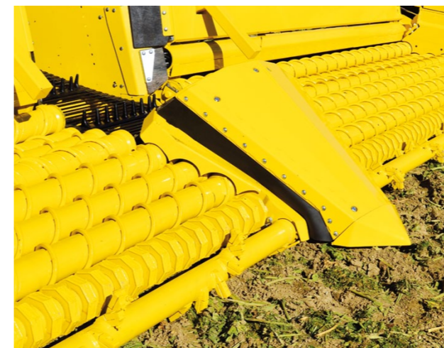
Разрыхлитель бурта со сменным наконечником и отдельными щитками имеет прочный привод с коническими роликовыми подшипниками и автоматической смазкой.
