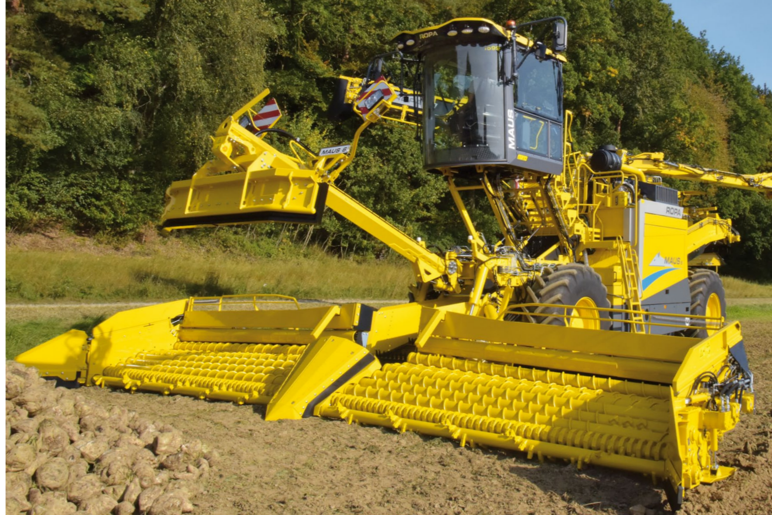
Отдельные приводы для 3-х групп валцов с индивидуально регулируемым числом оборотов и автоматическим реверсом защиты от камней. Все валцы в стандартной комплектации с наварными твердосплавными швами.
