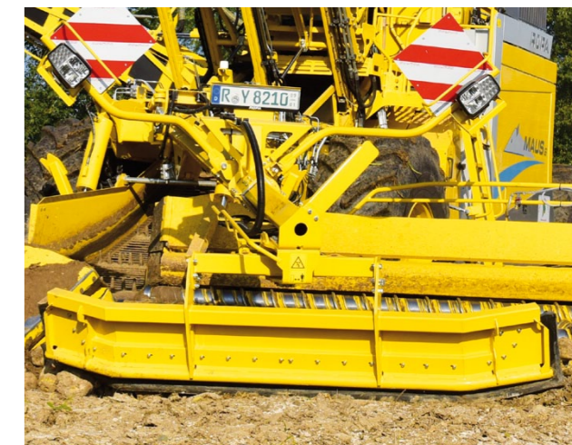
Манипулятор и подборщик остатков свеклы с загнутыми углами и усиленной резиновой накладкой.
