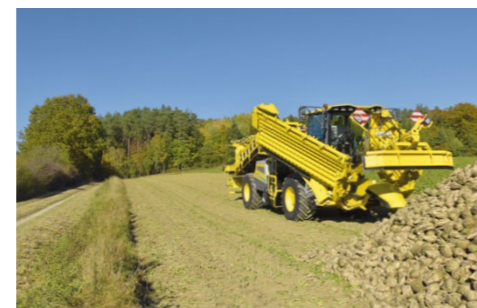
Отдельные приводы для 3-х групп валцов с индивидуально регулируемым числом оборотов и автоматическим реверсом защиты от камней. Все валцы в стандартной комплектации с наварными твердосплавными швами.
