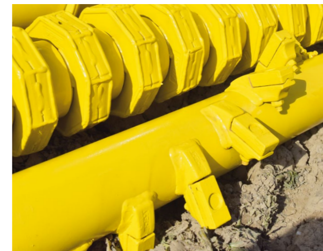
Dita di raccolta sostituibili e resistenti all'usura con inserto in metallo duro, rulli pulitori con dischi ottagonali forgiati e rivestimento duro.
