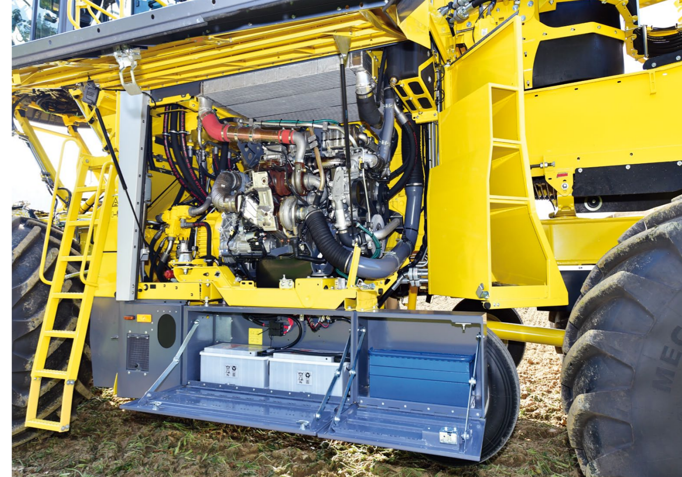
Mercedes-Benz OM936: per un ciclo di carico con numero di giri del motore fortemente ridotto (possibile da 1.150 1/min) e notevoli riserve di forza nelle condizioni più estreme.
