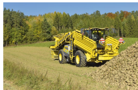
Azionamenti separati per 3 gruppi di rulli con regolazione individuale del numero di giri e riserva automatica per dispositivo di prevenzione blocco da pietre. Tutti i rulli sono saldati di serie.
