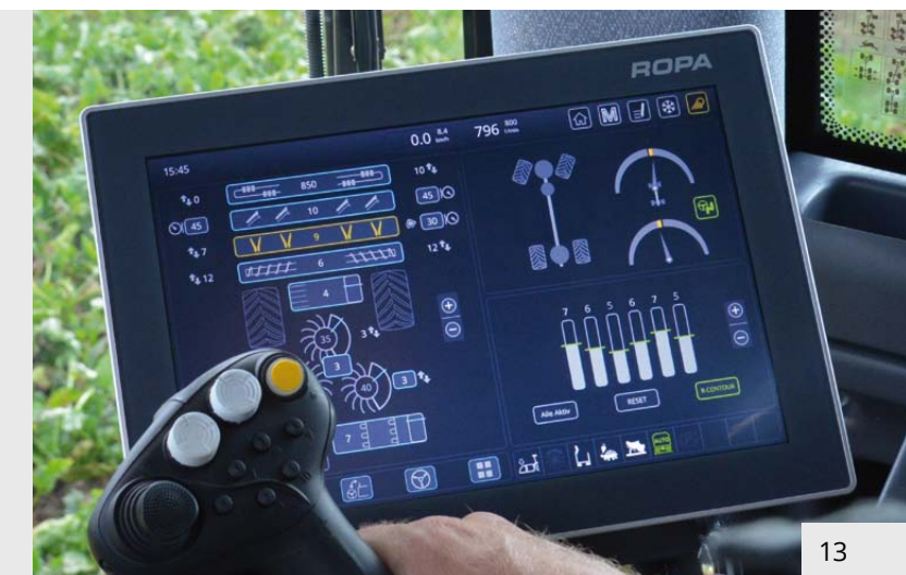
Автоматическая регулировка глубины лемехов при неоднородном контуре почвы Ультразвуковые датчики возле каждого ряда свеклы определяют поверхности почвы
