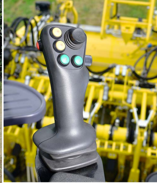
Элемент управления на левом подлокотнике для точного управления выгрузкой бункера
