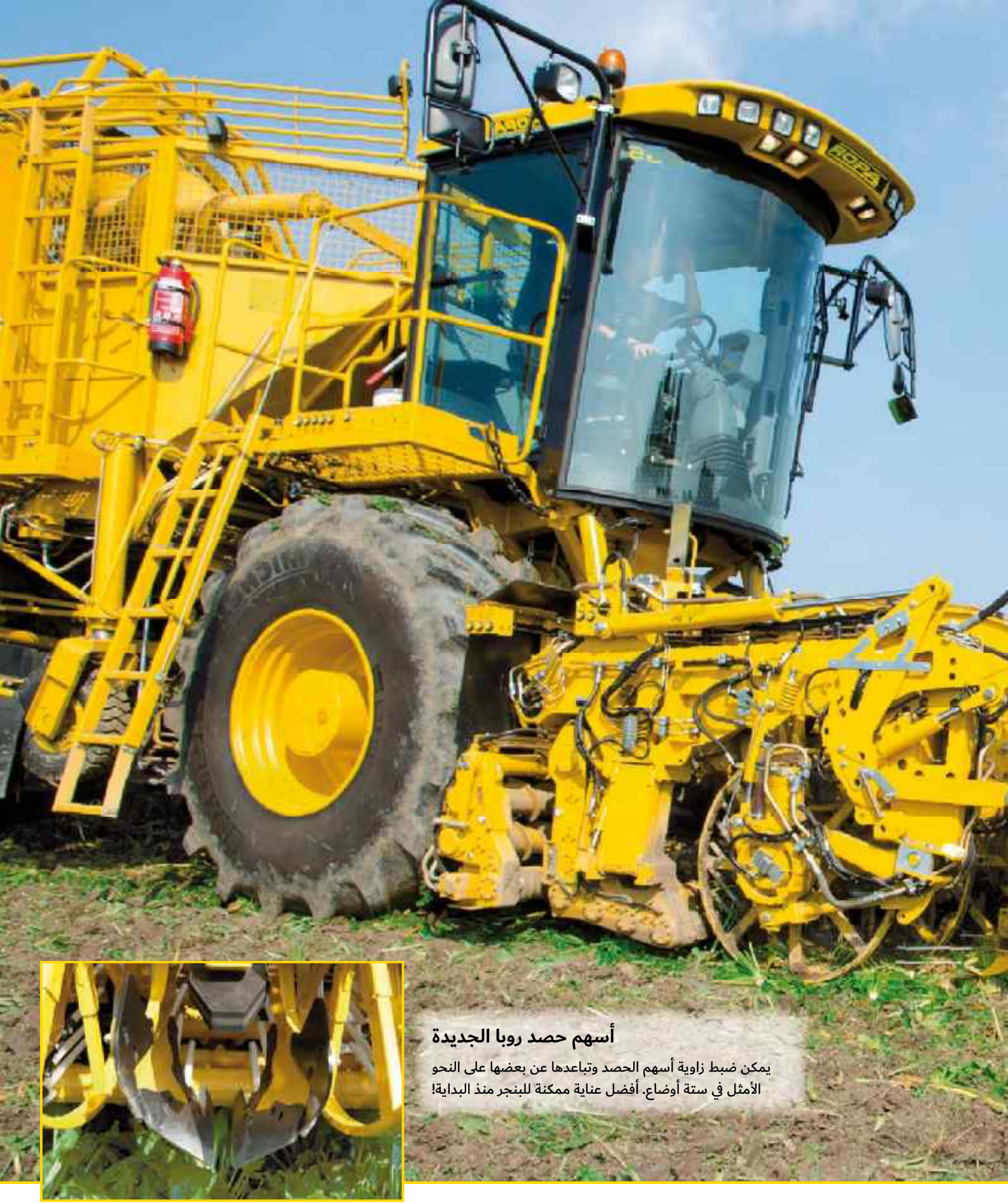
التعديل الهيدروليكي لارتفاع بكرات التنظيف
