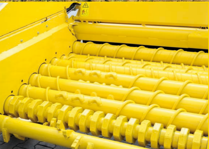
محركات منفصلة لـ 3 مجموعات بكرات مع ضبط فردي للسرعة وعكس تلقائي للأحجار العالقة
