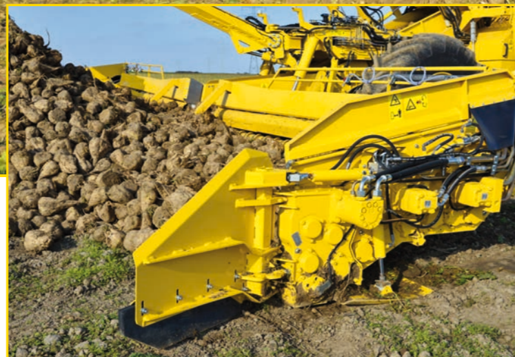
محركات منفصلة لـ 3 مجموعات بكرات مع ضبط فردي للسرعة وعكس تلقائي للأحجار العالقة
