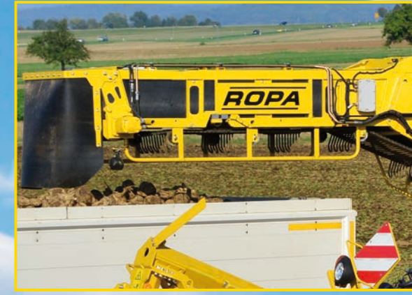
تكامل تام لنظام الوزن (اختياري) يتم دمج ميزان ، ومستشعر السرعة ، ومستشعر الزاوية ، ومكبيوتر الوزن في مفصلية ناقل الشاحنة
