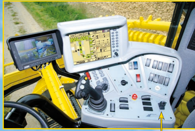
شاشة وحدة التحكم متعددة الوظائف عن طريق عنصر تحكم واحد فقط يمكن طي وفرد الماكينة تلقائيًا
