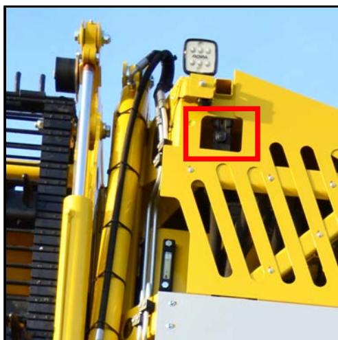
Telecamera nastro di scarico
