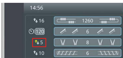
Regolazione automatica della profondità del vomere attivata
