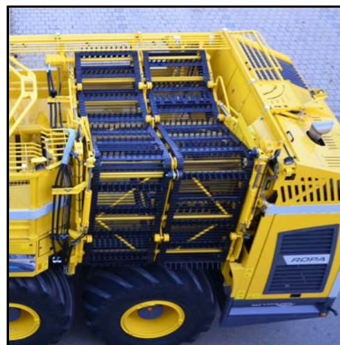
Tömningsbandled 1 och 2 i transportläge
