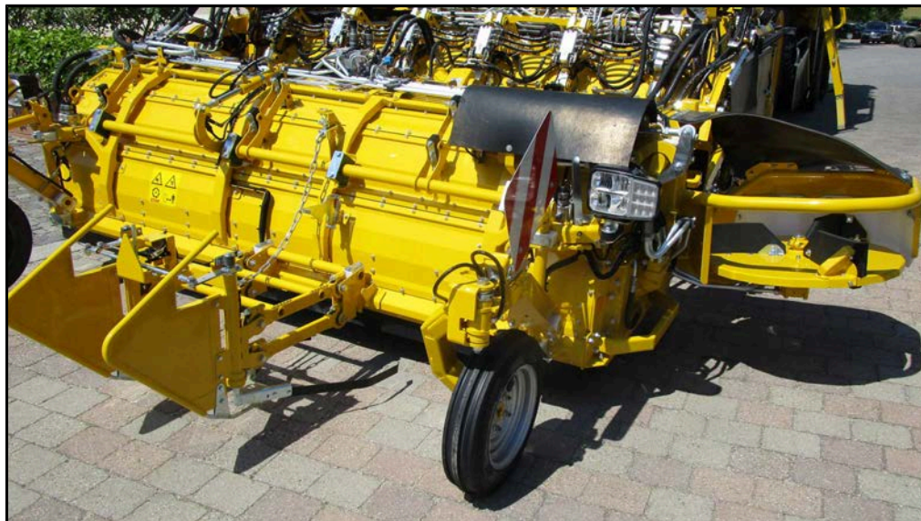
RASW-blastare, blastarlucka uppe
