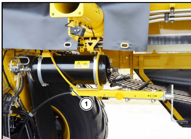
(1) Serbatoio dell'aria compressa con valvola di scarico
