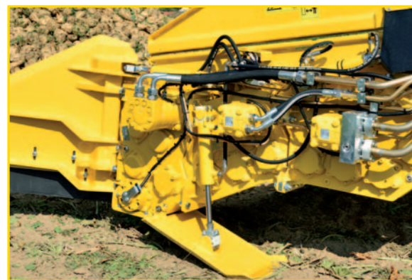
Azionamenti separati per 3 gruppi di rulli con regolazione individuale del numero di giri e inversione automatica per dispositivo di prevenzione blocco da pietre
