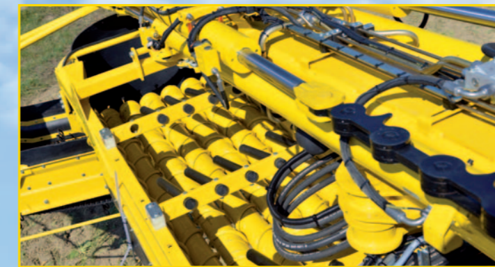
Dispositivo di pulitura a rulli con freno per barbabietole (in opzione)
