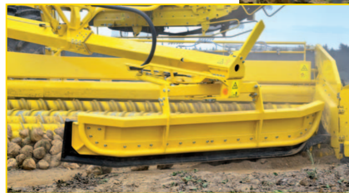
Raccogliatore barbabietole residue resistente con angoli ripiegati, controllabile proporzionalmente
