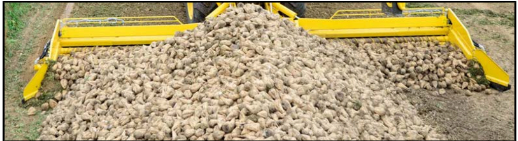
Toplama levhalarının yanlış ayarı. Toplama levhalarının bulunduğu alanda anlamsız toprak yığınları. Yığına yanlış sürüş. Yığına mümkün olduğunca ortadan yaklaşılmalıdır.
