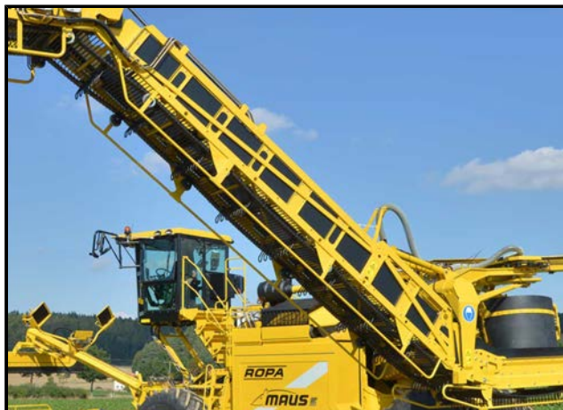
Elevator spänd korrekt
