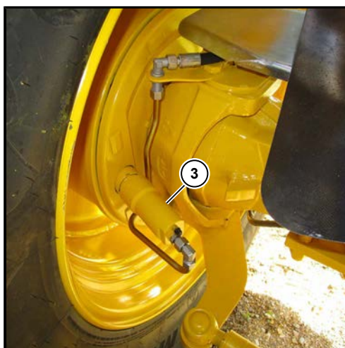
(3) Bakaxel med hydrauliskt månövrerad trumbroms
