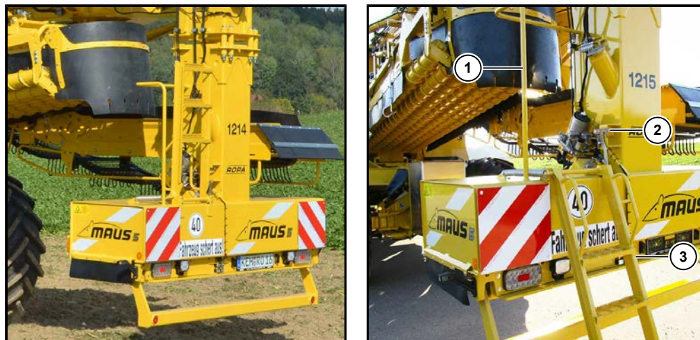
Scaletta ausiliaria sul serbatoio del carburante in posizione guida su strada e/o ribaltata per fare rifornimento
