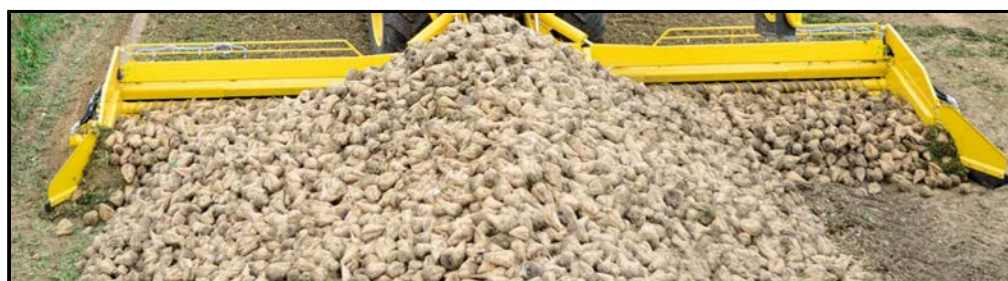
Impostazione errata delle paratie anteriori laterali. Accumulo di terra inutile intorno alle paratie anteriori laterali. Accostamento errato al cumulo. Ci si dovrebbe accostare il più centralmente possibile.
