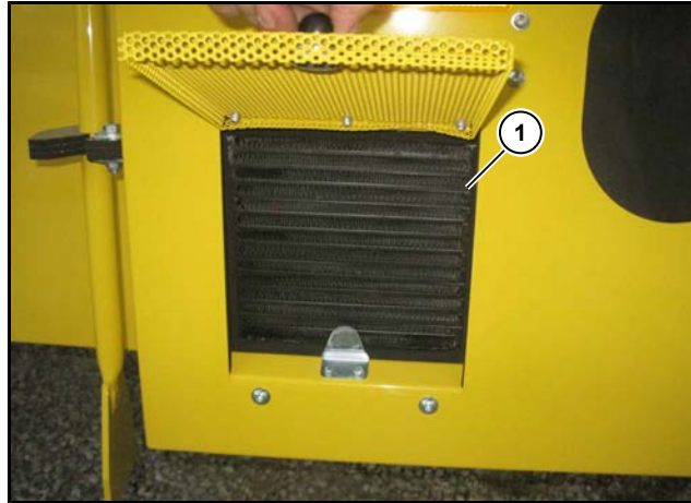
(1) Radiatore olio ripartitore di coppia della pompa
