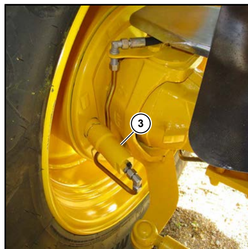
(3) Assale posteriore con freno a tamburo azionato idraulicamente
