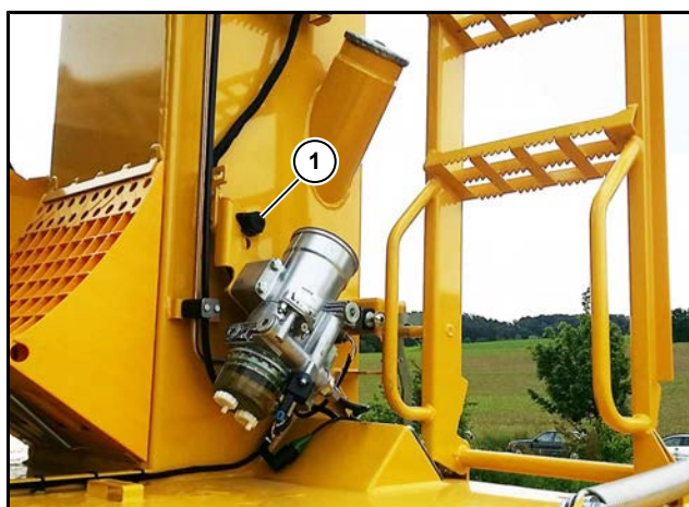
(1) Presa sul serbatoio del carburante
