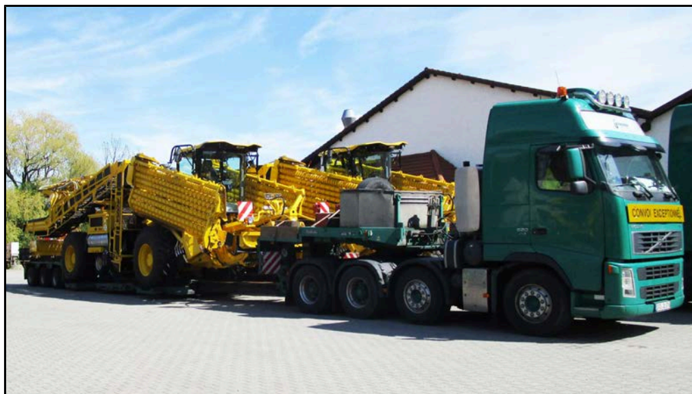
Normale rimorchio con pianale ribassato per trasporto su strada con altezza di trasporto minima
