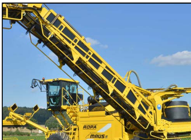
Nastro di scarico correttamente teso
