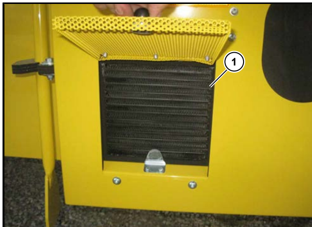
(1) Hladnjak ulja razdjelnog prijenosnika pumpe
