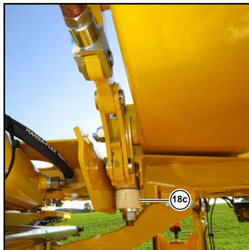
(18c) Blokada protutežnog kraka je zatvorena
