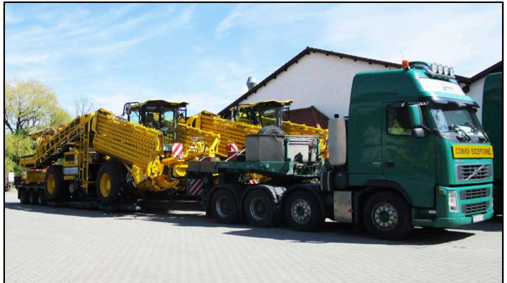
Propisana labudica za cestovni transport s minimalnom transportnom visinom
