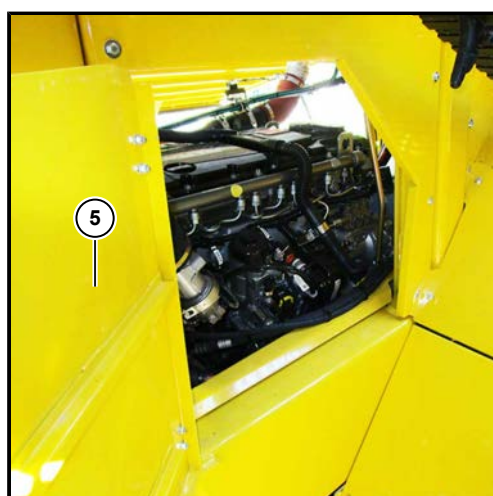
(5) Poklopac za održavanje kućišta motora u kanalu transportne trake
