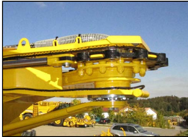
Okretanje lančanog prijenosa pretovarivača
