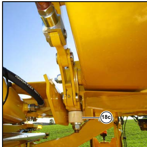
(18c) Vastapainovarren lukitus suljettuna
