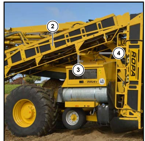
Lastauselevaattori asetettuna oikein kuljetustuen ylle
