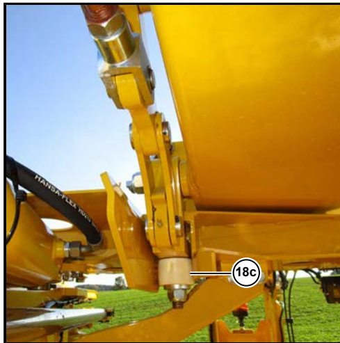
Vastapainovarren lukitus suljettuna
