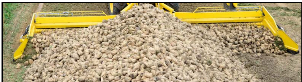
Raivauskilpien väärä säätö. Tarpeettomia maakasautumia raivauskilpien alueella. Lisäksi väärä tapa lähestyä kasaa. Sitä tulee lähestyä mahdollisimman tarkasti keskilinjaa seuraten.
