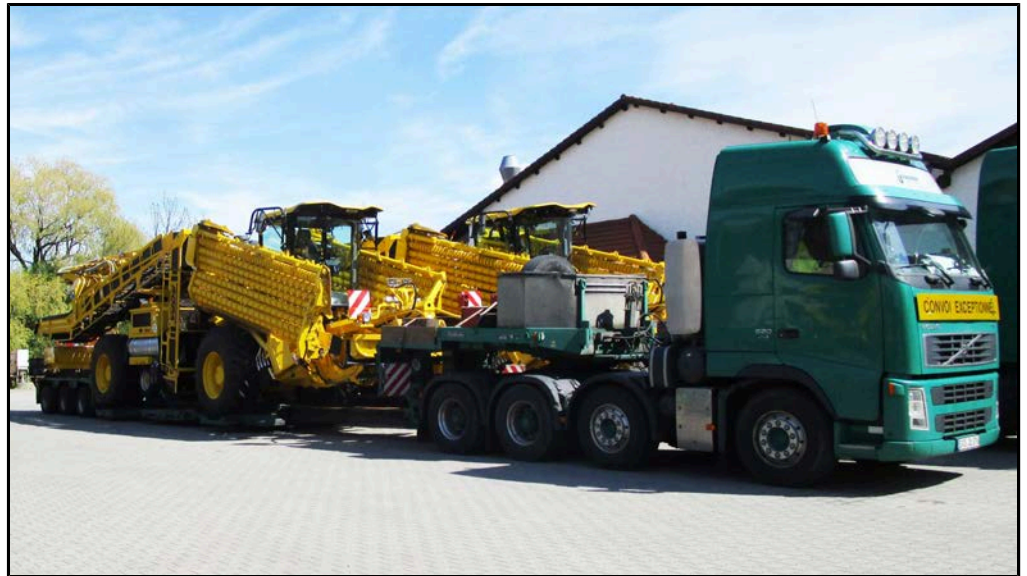
Varsinainen syväkuormauskuljetusauto katukuljetusta varten, kuljetuskorkeus minimaalinen
