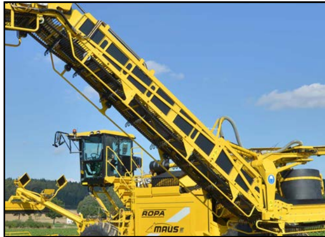
Lastauselevaattori kiristettynä oikein
