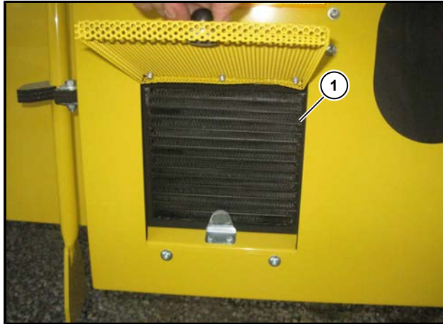
(1) Pumpun jakovaihteiston öljynjäähdytin
