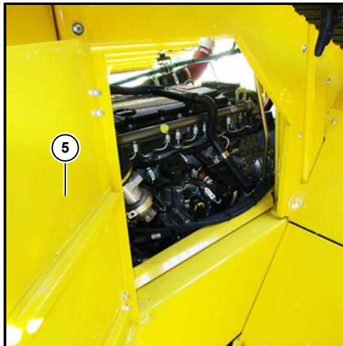
(5) Keskimaton kanavassa olevan moottorikotelon huoltoluukku
