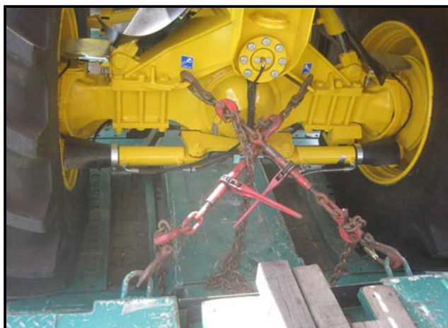
Fastsurringspunkter ved bagakslens konsol
