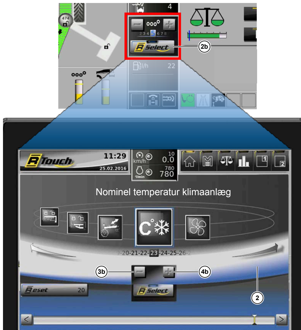
R-Select tilstand (som et eksempel er klimaanelæggets nominelle temperatur valgt)
