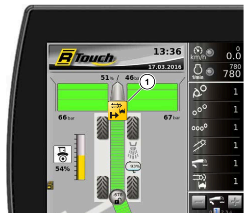
(1) Mærke, der angiver aktiveret læssetilstand BEGYND
