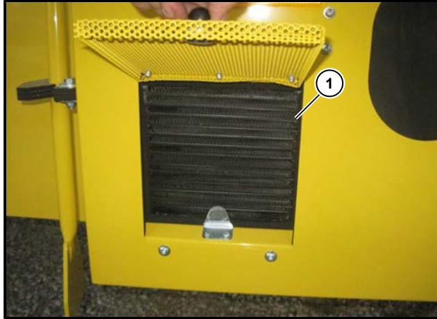
(1) Oliekøler til pumpefordelergear
