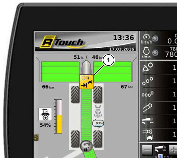
(1) Mærke, der angiver aktiveret læssetilstand SLUT
