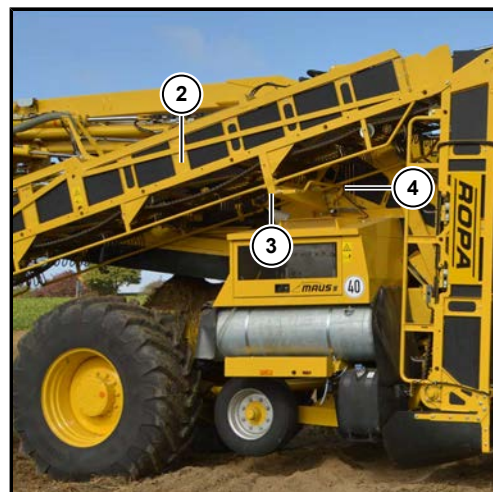
Aflæsseren hviler korrekt på transportstøtten
