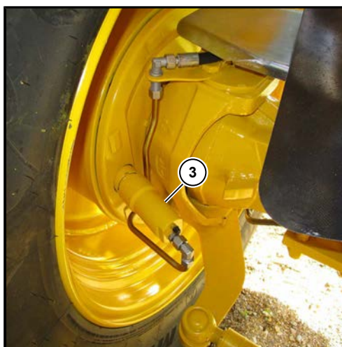
(3) Bagaksel med hydraulisk aktiveret tromlebremse
