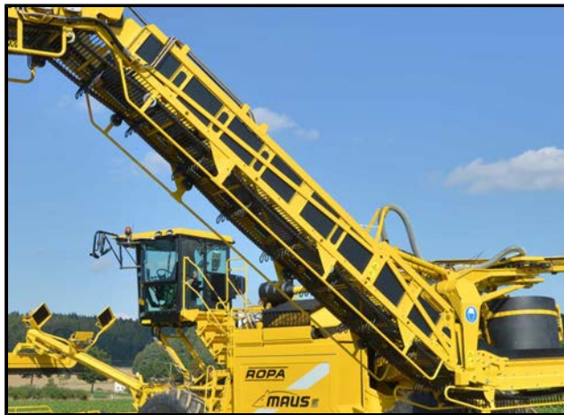
Korrekt strammet aflæsserbånd
