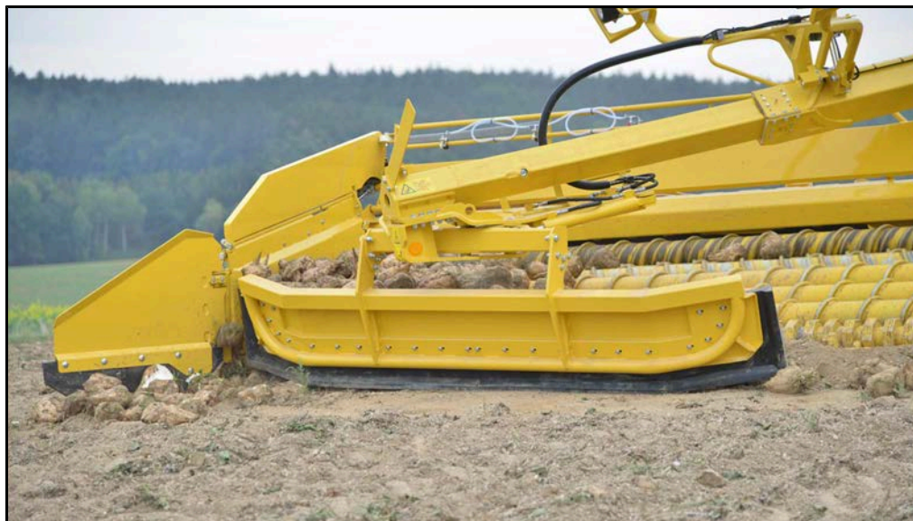
Roer i kanten af kulen kan lettere opsamles, hvis man klapper rømmpladerne indad
