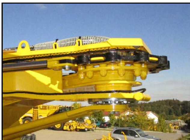
Drejning af kædedrev på aflæsser
