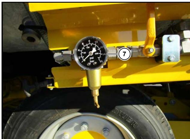
(7) Trykreduktionsventil til vandsprøjteanlægget
