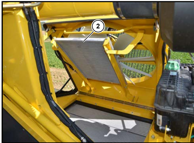
(2) 空调设备冷凝器
