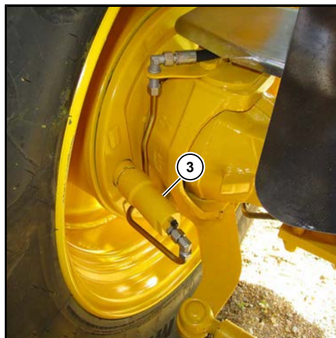
(3) 后轴包含液压鼓式制动器
