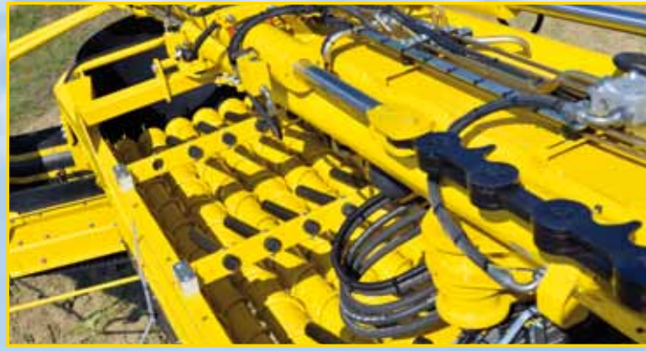
包含甜菜流制动装置的钳状辊筒清洁装置 (可选)
