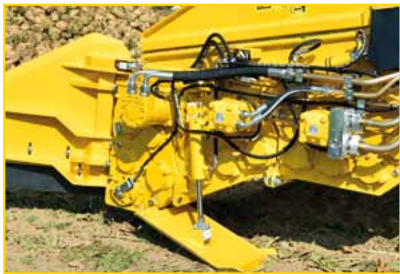
3个辊筒组，各自独立的驱动装置，支持转速调节和石块卡塞时的自动倒转。
