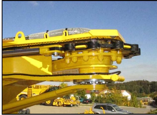
Yükləyici qolu döndərən zəncirli güc sistemi
