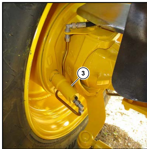
(3) Hidravlik çalışan barabanlı əyləci olan arxa körpü
