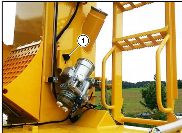
(1) Yanacaq çəninin üzərində olan elektrik çıxışı
