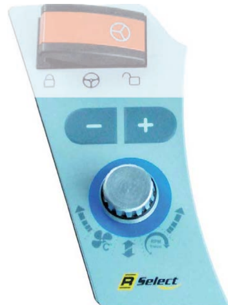
Sollevamento/abbassamento della coclea cassone solo nella parte posteriore
