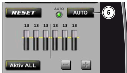
con regolazione automatica della profondità del vomere
