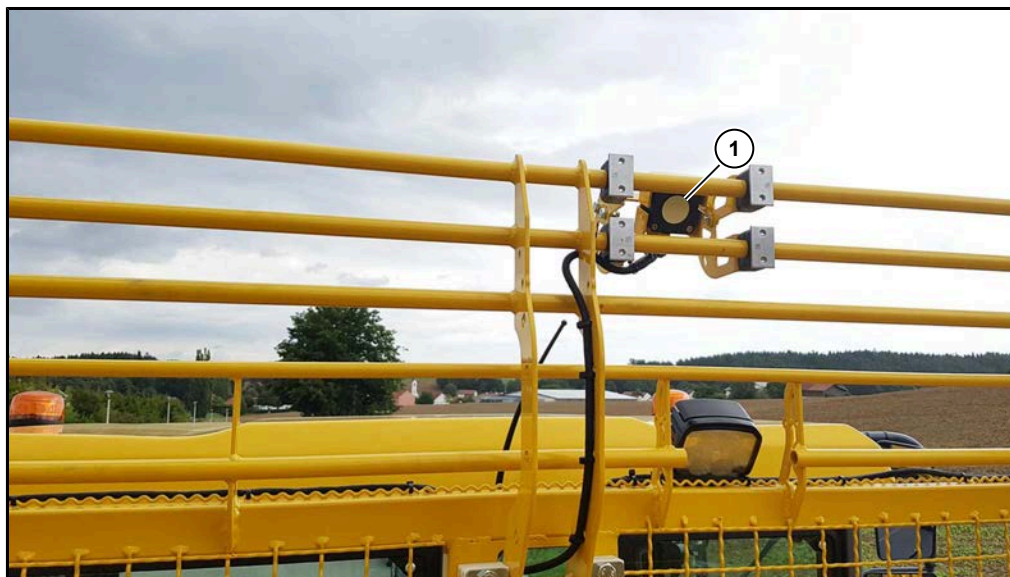
(1) Sensore a ultrasuoni anteriore
