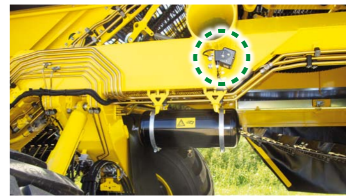
Elek zinciri, ot zinciri, çapa, ayıklama tezgahı, depo için ek kameralar ve geri görüş kamerası
