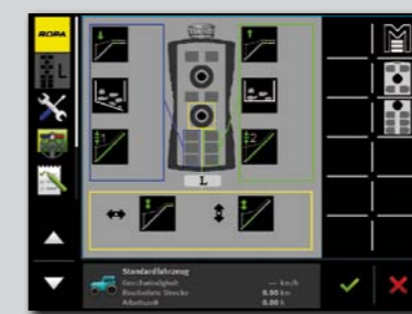
Yükleme deposu için sol kumanda elemanı, varsayılan yerleşim 2
