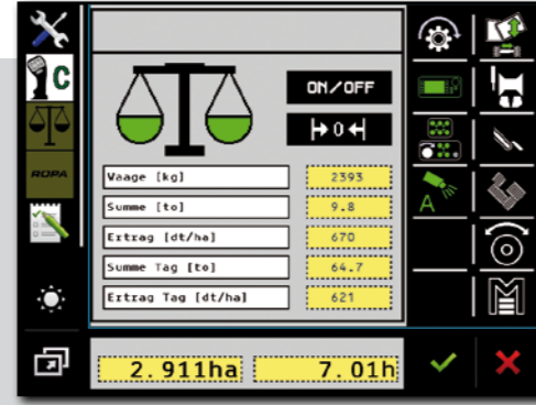
Ölçüm verileri özeti ve ayar seçeneklerini içeren Potato Scale terminal ekranı
