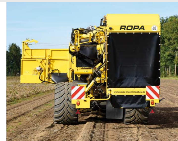
Hydraulisk lutningskompensation som standard - optimerad rensning och mer komfort åt sorterarna
