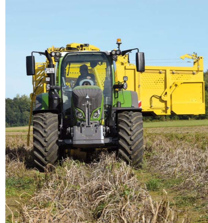
Körspårupptagning med inskjuten teleskopaxel - ingen överkörning av potatisraderna
