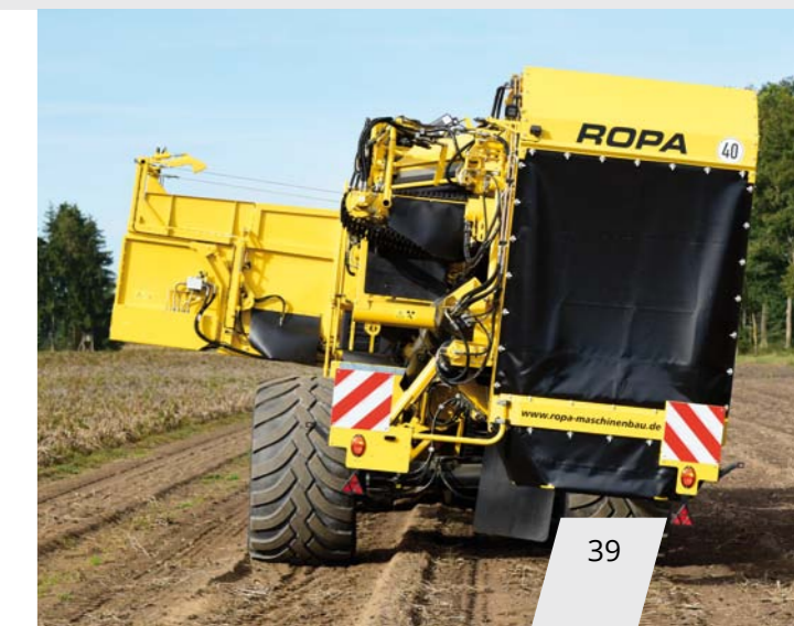
Hydraulisk lutningskompensation som standard - optimerad rensning och mer komfort åt sorterarna
