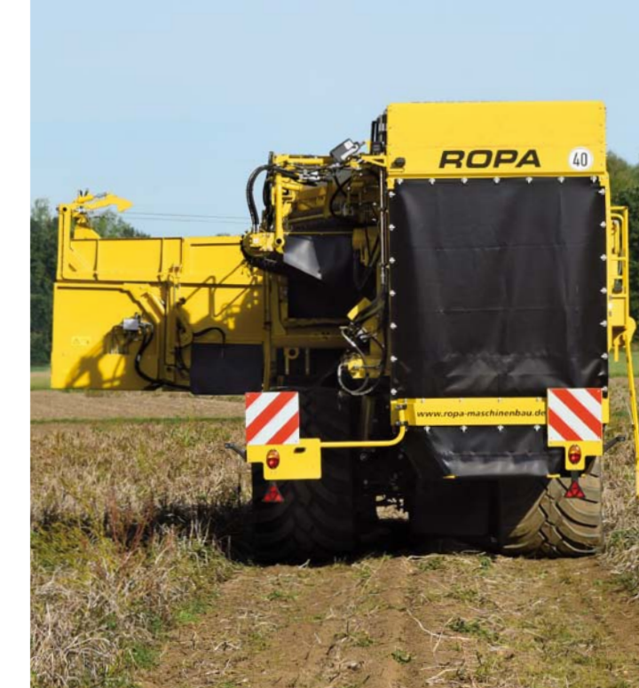
Körspårupptagning med inskjuten teleskopaxel - ingen överkörning av potatisraderna
