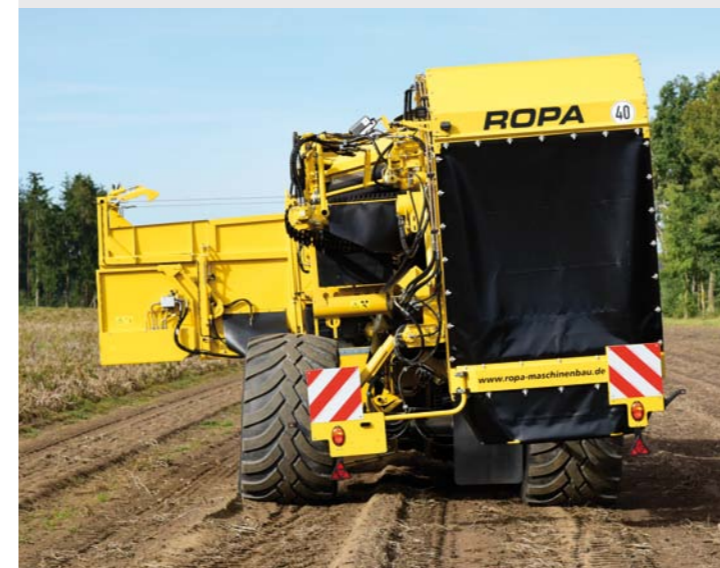
Hydraulisk lutningskompensation som standard - optimerad rensning och mer komfort åt sorterarna
