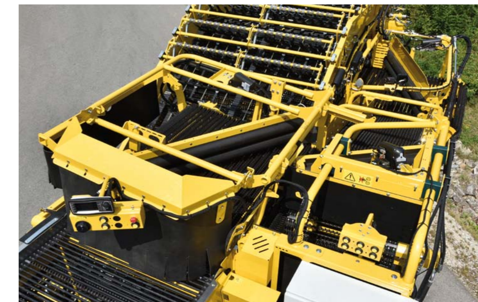
Keiler 2 L с 4 игольчатыми тр-рами без транспортера примесей и сортировочной платформы справа
