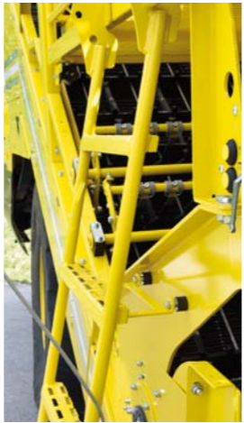
Складная лестница с амортизированием для безопасного использования
