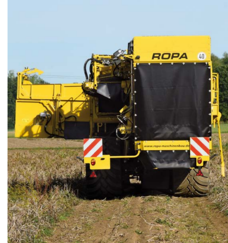
Разбитие загонки с задвинутой телескопической осью - без наезда на гребень картофеля
