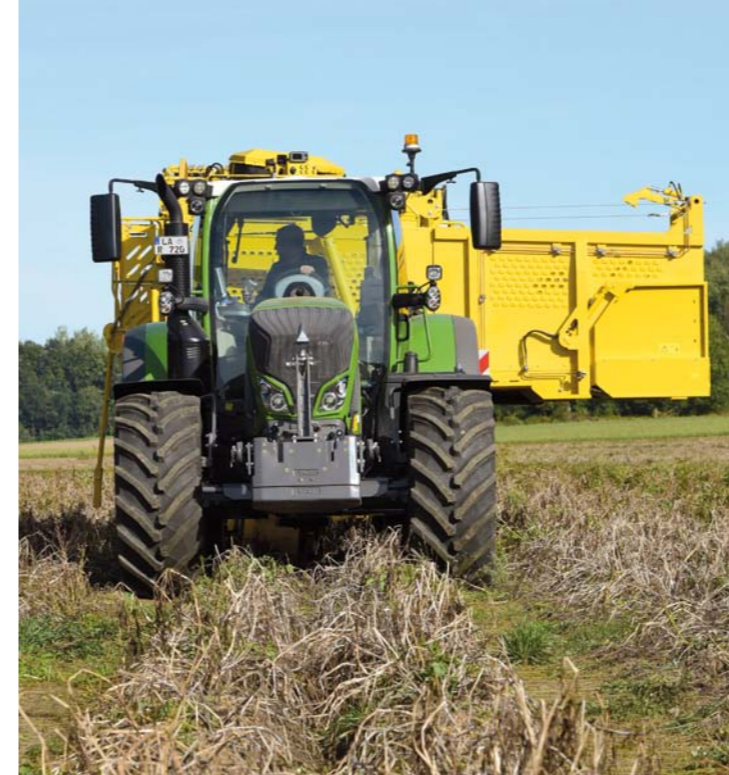
Разбитие загонки с задвинутой телескопической осью - без наезда на гребень картофеля
