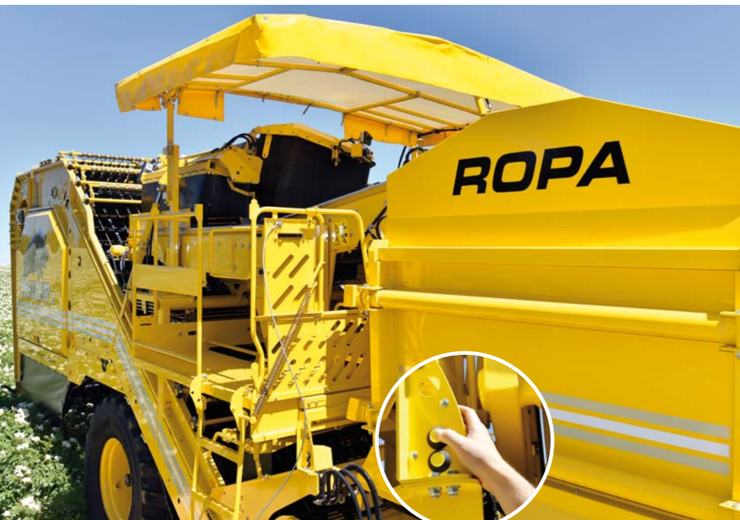
Регулируемый по высоте навес (опционально, расширяемый на величину боковой обшивки)
