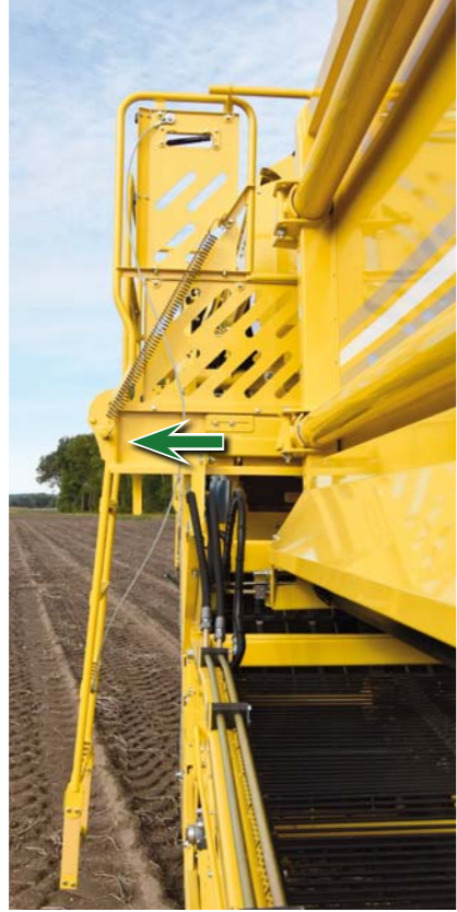
Рабочая платформа раздвигается на 300 мм - большая рабочая площадь для свободы передвижения
