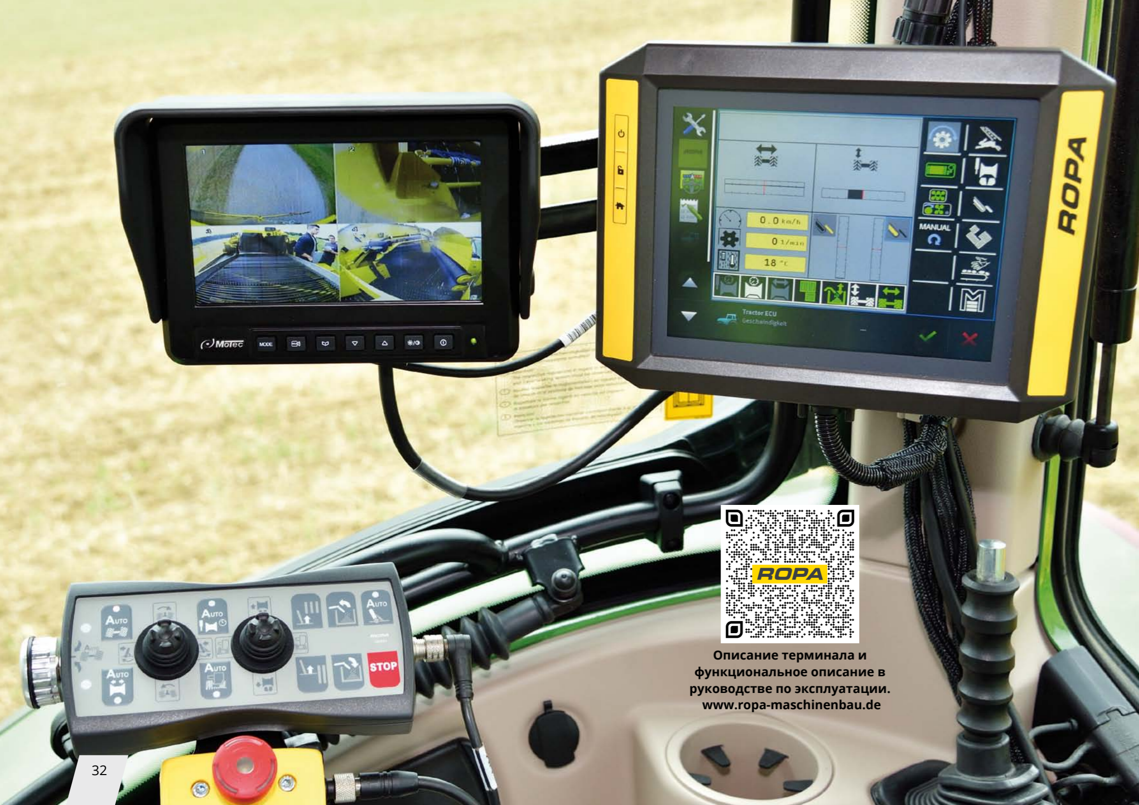
Полностью свободно программируемый элемент управления по норме ISOBUS AUX-N
