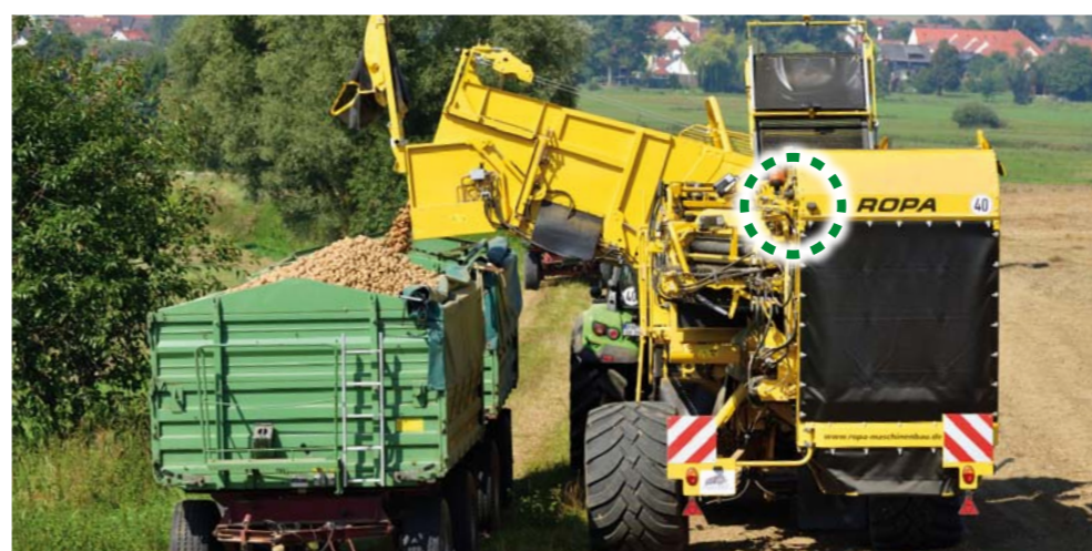
Дополнительные камеры для просеивающего транспортера, транспортера ботвы, игольчатого транспортера, бункера и камера заднего вида
