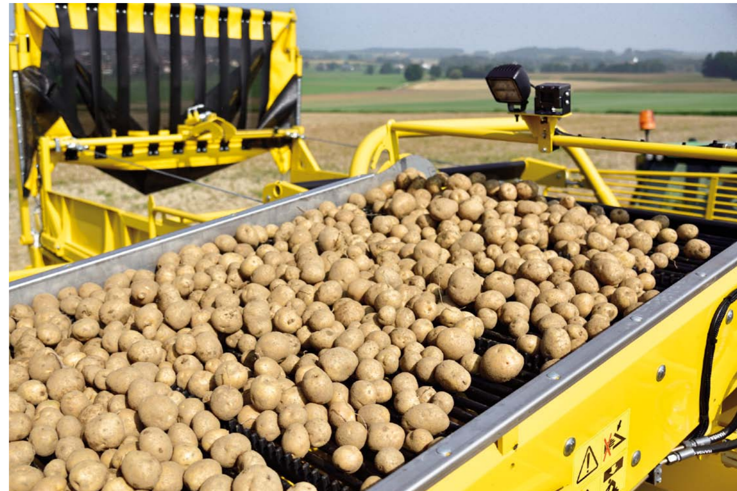
Дополнительные камеры для просеивающего транспортера, транспортера ботвы, игольчатого транспортера, бункера и камера заднего вида
