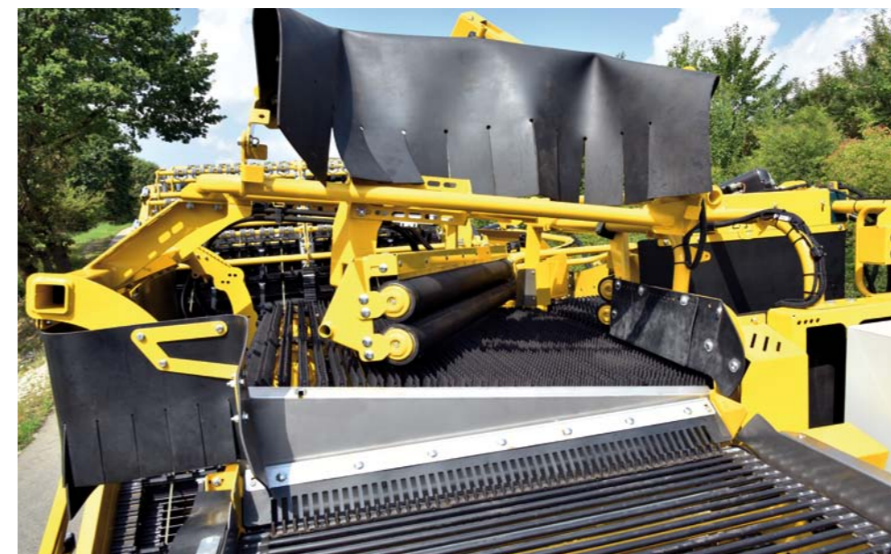
Keiler 2 с 4 игольчатыми тр-рами с отводящими вальцами
