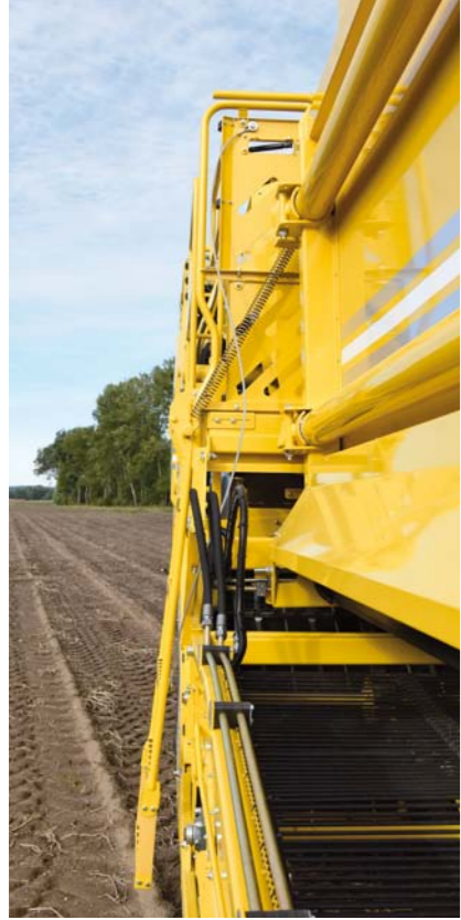
Рабочая платформа раздвигается на 300 мм - большая рабочая площадь для свободы передвижения
