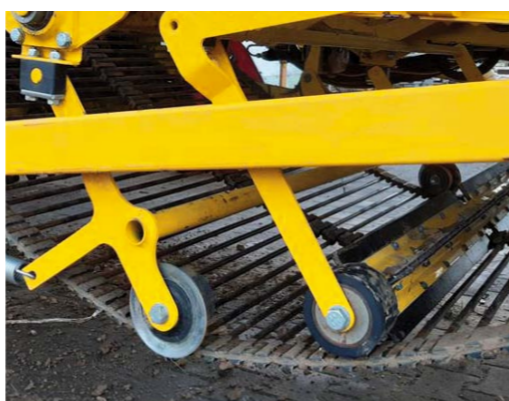
Натяжное устройство просеивающих транспортеров с отдельным, выдвигающимся вальцом очистки
