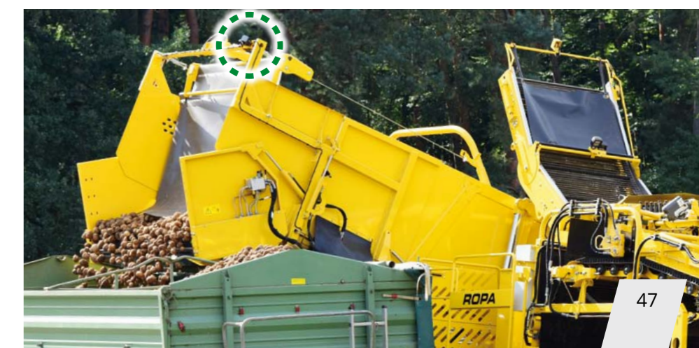
Telecamere supplementari per nastro di setacciamento, nastro defogliatore, riccio, tavolo di selezione, cassone e telecamera per la retromarcia
