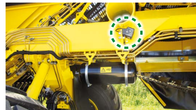
Telecamere supplementari per nastro di setacciamento, nastro defogliatore, riccio, tavolo di selezione, cassone e telecamera per la retromarcia
