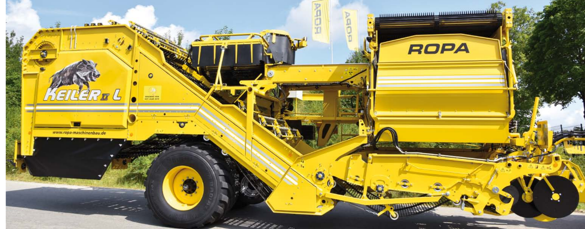
Keiler 2 L Riccio 4 senza nastro scarti e senza banco di selezione a destra
