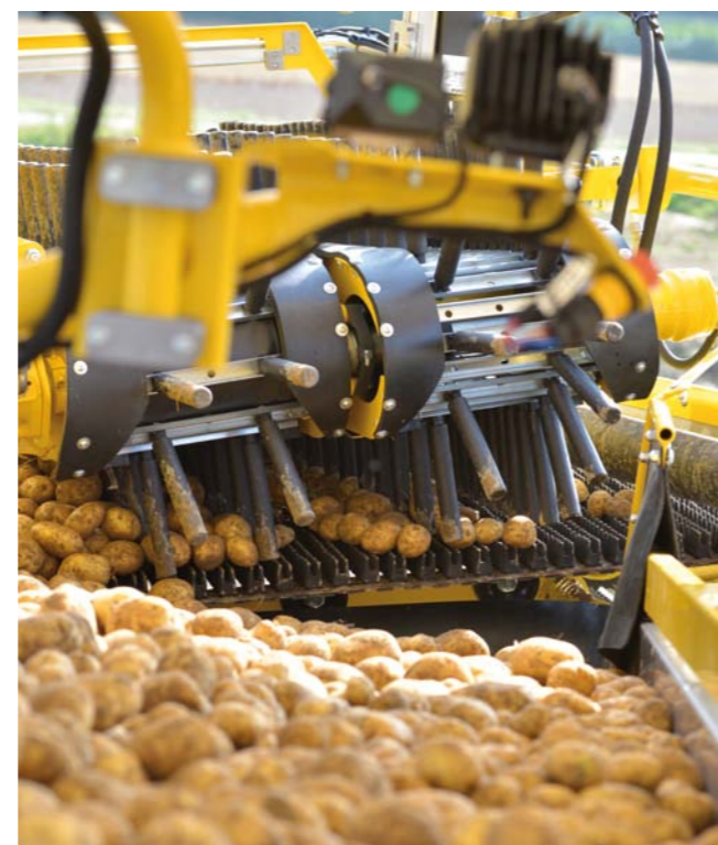
Keiler 2 Classic con pettine a dita perimetrale, corsia scarti e rulli di smistamento
