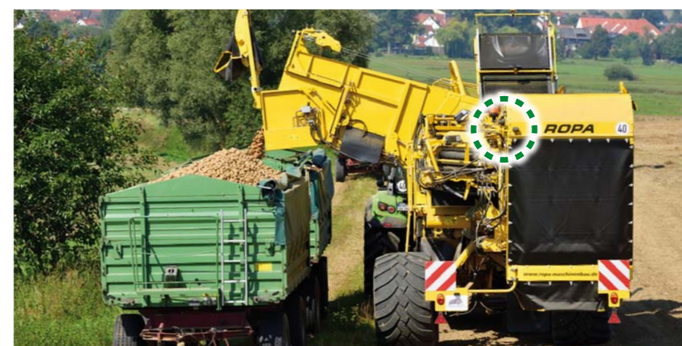
Telecamere supplementari per nastro di setacciamento, nastro defogliatore, riccio, tavolo di selezione, cassone e telecamera per la retromarcia
