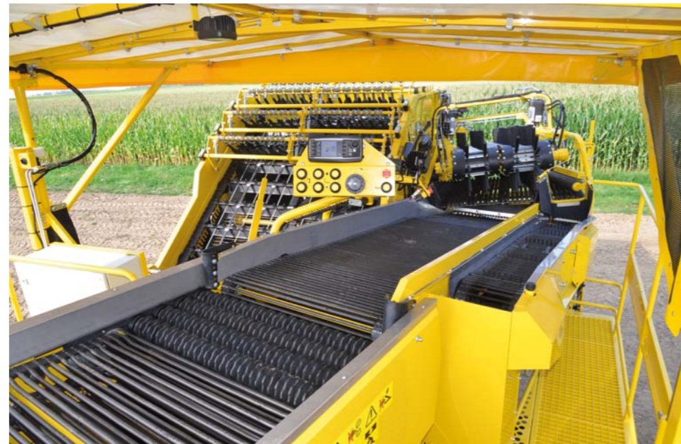
Keiler 2 Classic con pettine a dita perimetrale, corsia scarti e rulli di smistamento
