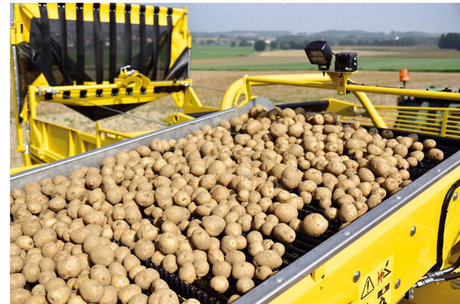
Telecamere supplementari per nastro di setacciamento, nastro defogliatore, riccio, tavolo di selezione, cassone e telecamera per la retromarcia
