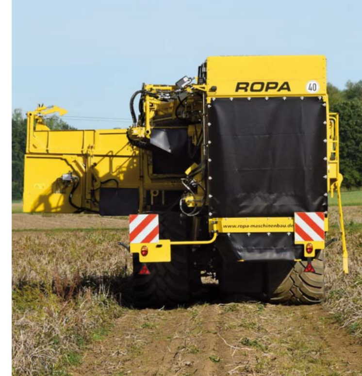
Ajouranosto teleskooppiakselin ollessa työnnettynä sisään – ei ajoa perunapenkin yli
