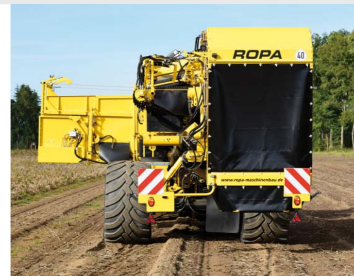
Vakiovarusteena hydraulinen rinteen kompensointi – optimoitu puhdistus ja enemmän mukavuutta lajitteluhenkilökunnalle
