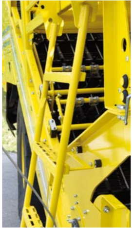
Taitettava tikasvaimennus takaa turvallisen nousun
