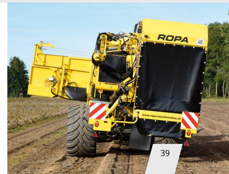
Vakiovarusteena hydraulinen rinteen kompensointi – optimoitu puhdistus ja enemmän mukavuutta lajitteluhenkilökunnalle
