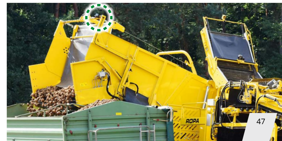
Lisäkamerat seulakuljettimelle, varsiketjulle, Igel-koneelle, lajittelupöydälle, säiliölle ja peruutuskameralle
