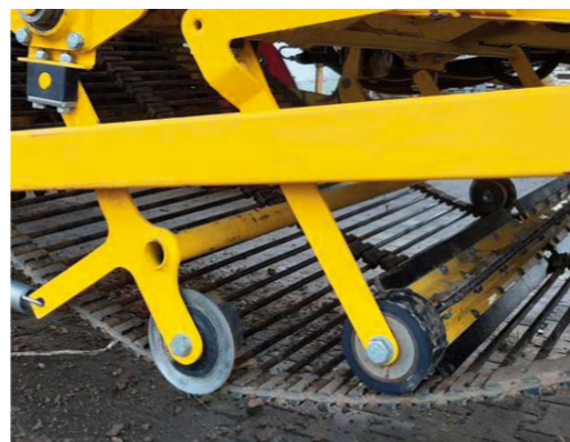
Seulakuljettimen kiristin erillisellä uloskäännettävällä puhdistusvalssilla varustettuna
