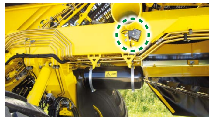
Lisäkamerat seulakuljettimelle, varsiketjulle, Igel-koneelle, lajittelupöydälle, säiliölle ja peruutuskameralle
