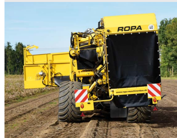
Vakiovarusteena hydraulinen rinteen kompensointi – optimoitu puhdistus ja enemmän mukavuutta lajitteluhenkilökunnalle
