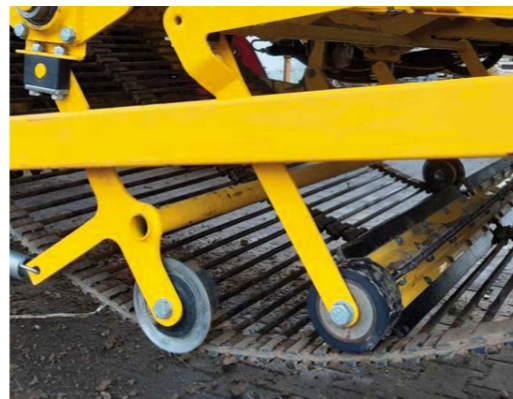
主筛带张紧装置，带独立的外摆式清洁辊筒
