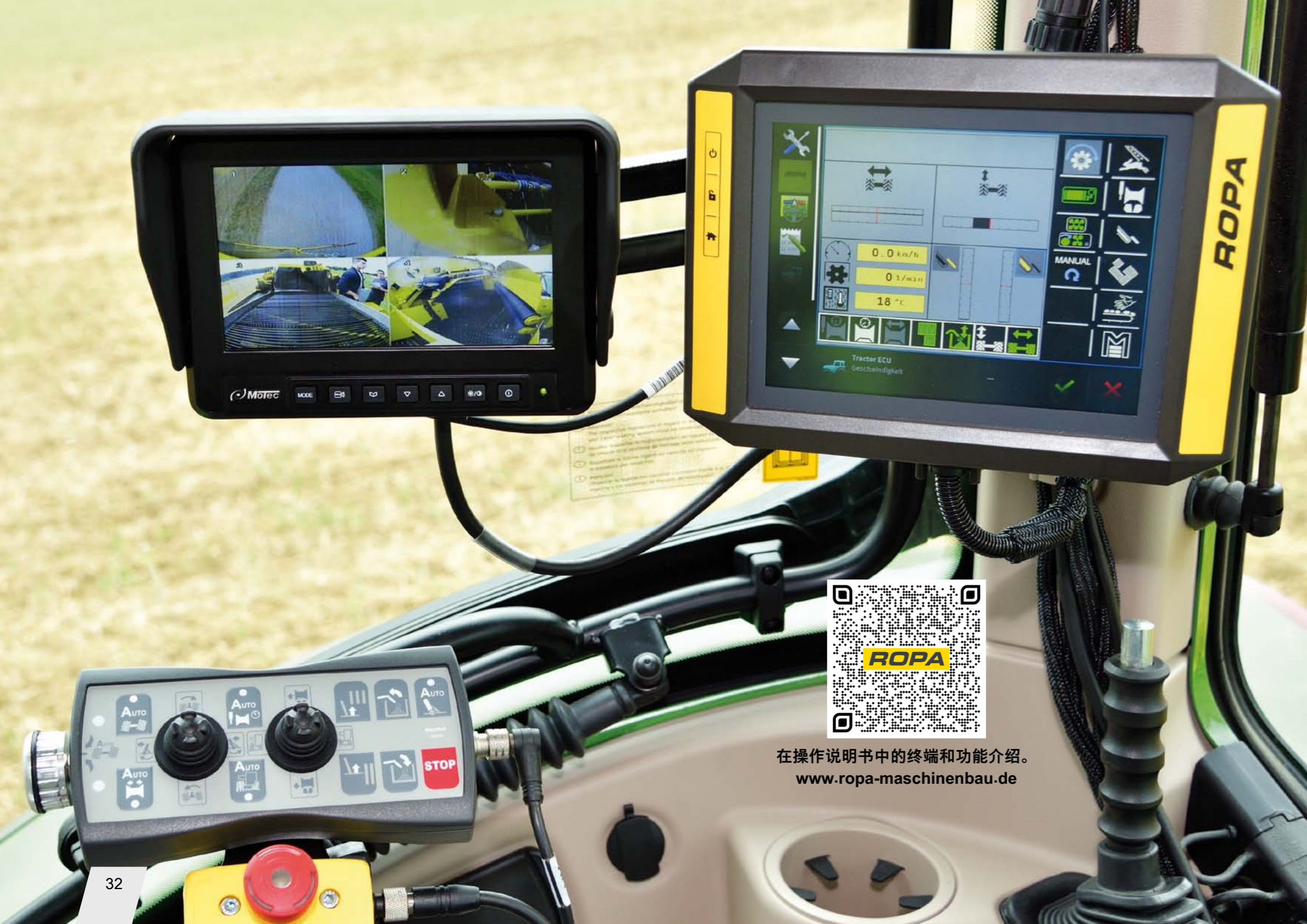
符合 ISOBUS AUX-N 标准、 可完全自由分配的操作元件
