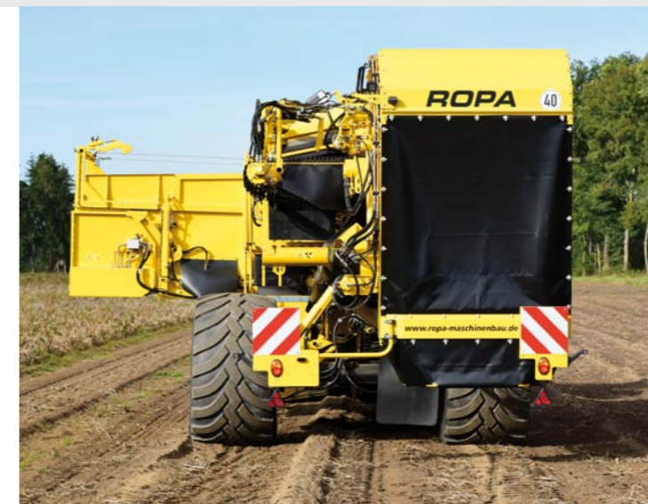
标配的液压斜坡平衡 - 清洁效果得到优化，且执行拣选作业的人员更加舒适
