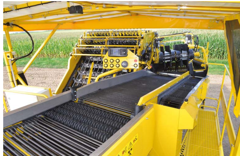
山猪 2 Classic 带旋转指状分离器、混合垃圾道和拣选辊筒
