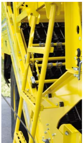
可折叠的梯子减振装置，自动防夹装置确保安全攀爬
