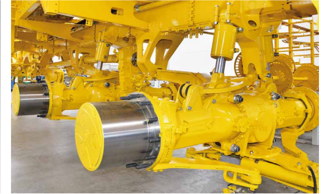
Hidravlik şassi sistemi, avtomatik əyim tarazlayıcısı
