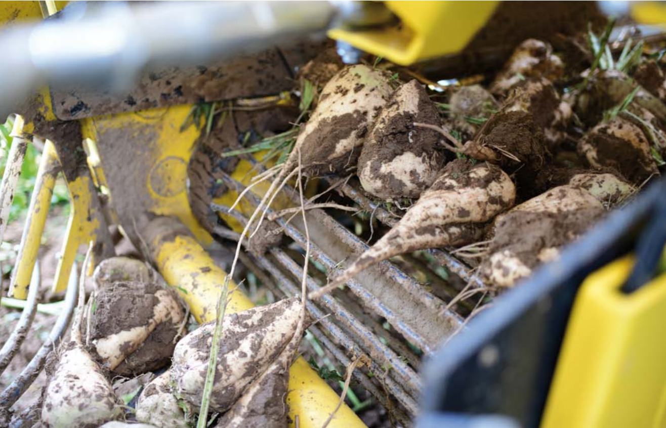
Fırlanan vallar elevator girişində torpaq yığılmasının qarşısını alır
