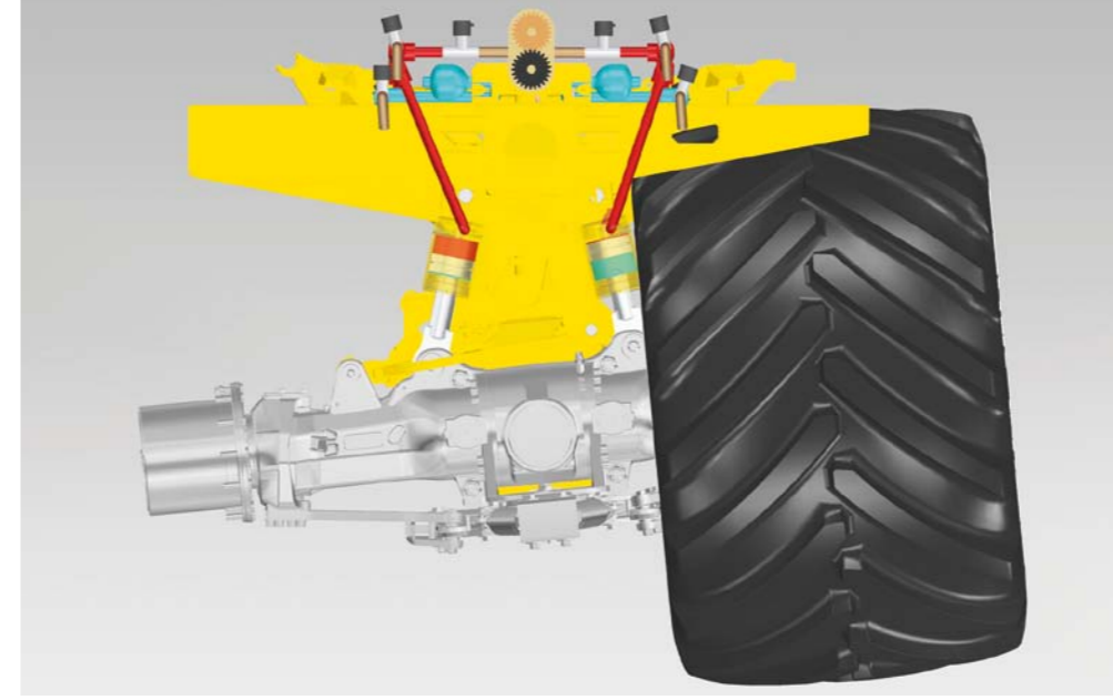
Hidravlik şassi sistemi, avtomatik əyim tarazlayıcısı
