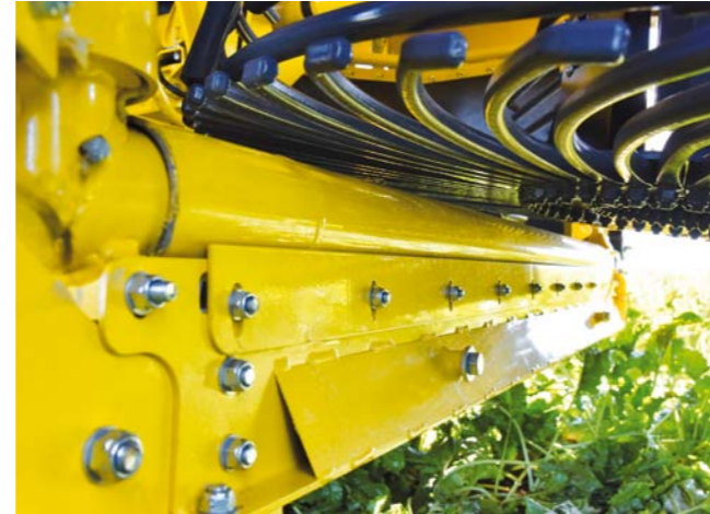
Fırlanan vallar elevator girişində torpaq yığılmasının qarşısını alır
