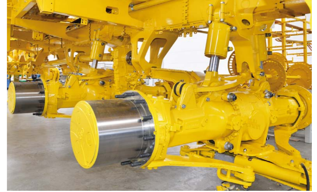
Hidravlik şassi sistemi, avtomatik əyim tarazlayıcısı
