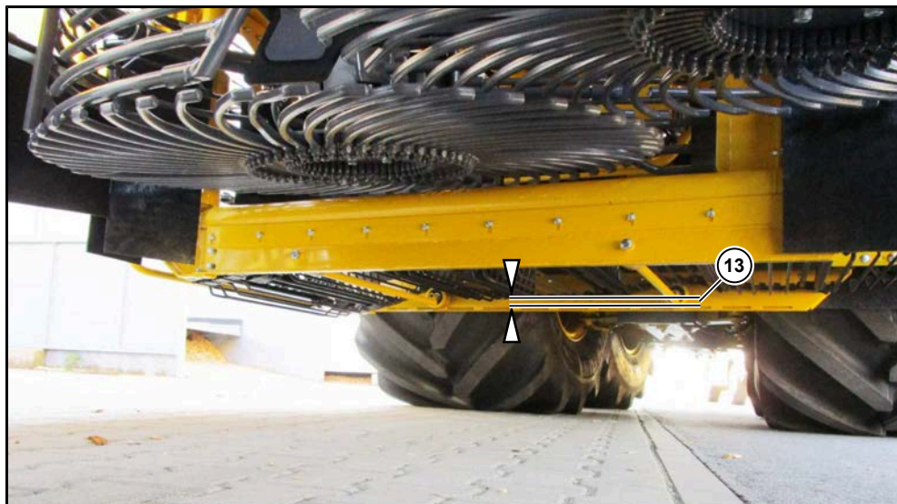
Bandă elevator tensionată corect
