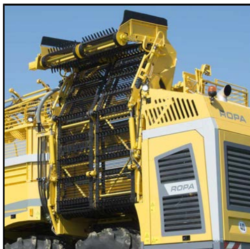
Piesele articulate 1 și 2 ale benzii de descărcare în poziție de recoltat rădăcini
