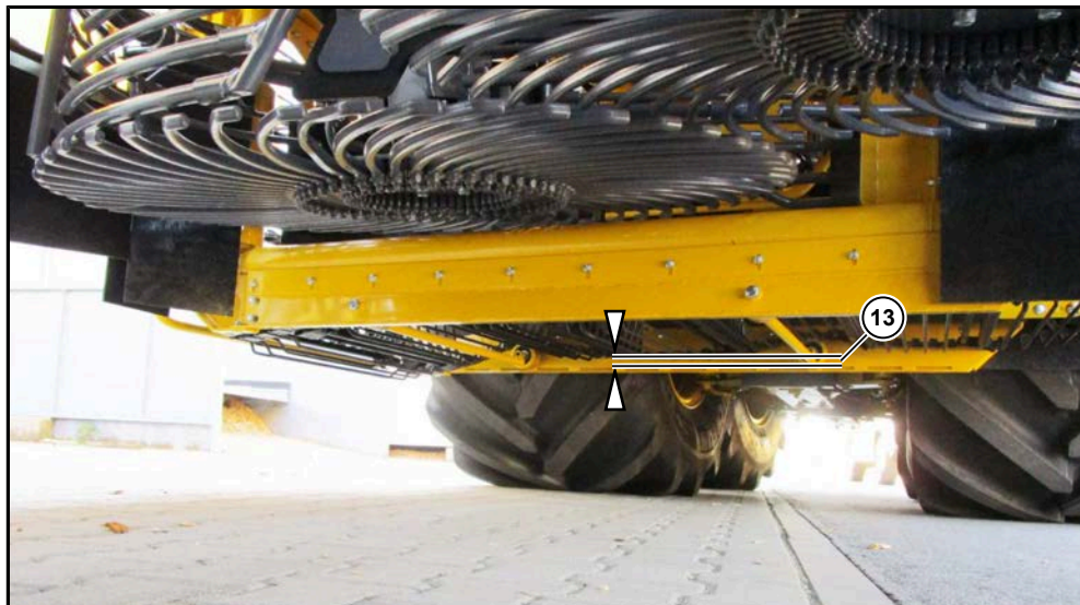
Nastro dell'elevatore correttamente teso
