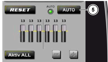
con regolazione automatica della profondità del vomere
