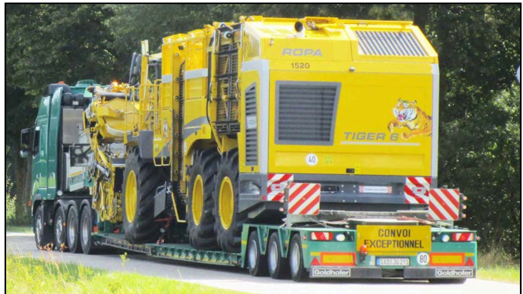
Normale rimorchio con pianale ribassato per trasporto su strada con altezza di trasporto minima
