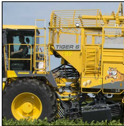
Stige til førerkabine i position for kørsel på vej hhv. roeoptagning
