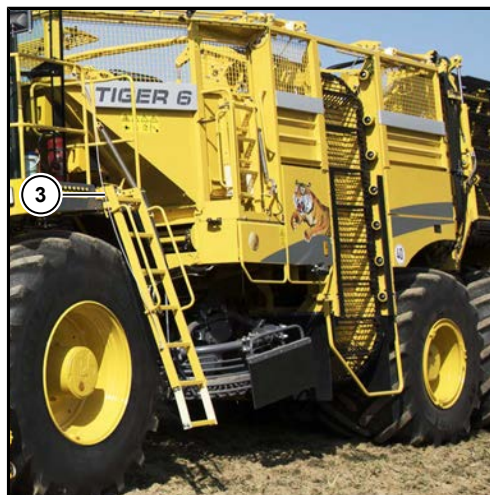
Stige til førerkabine i position for kørsel på vej hhv. roeoptagning
