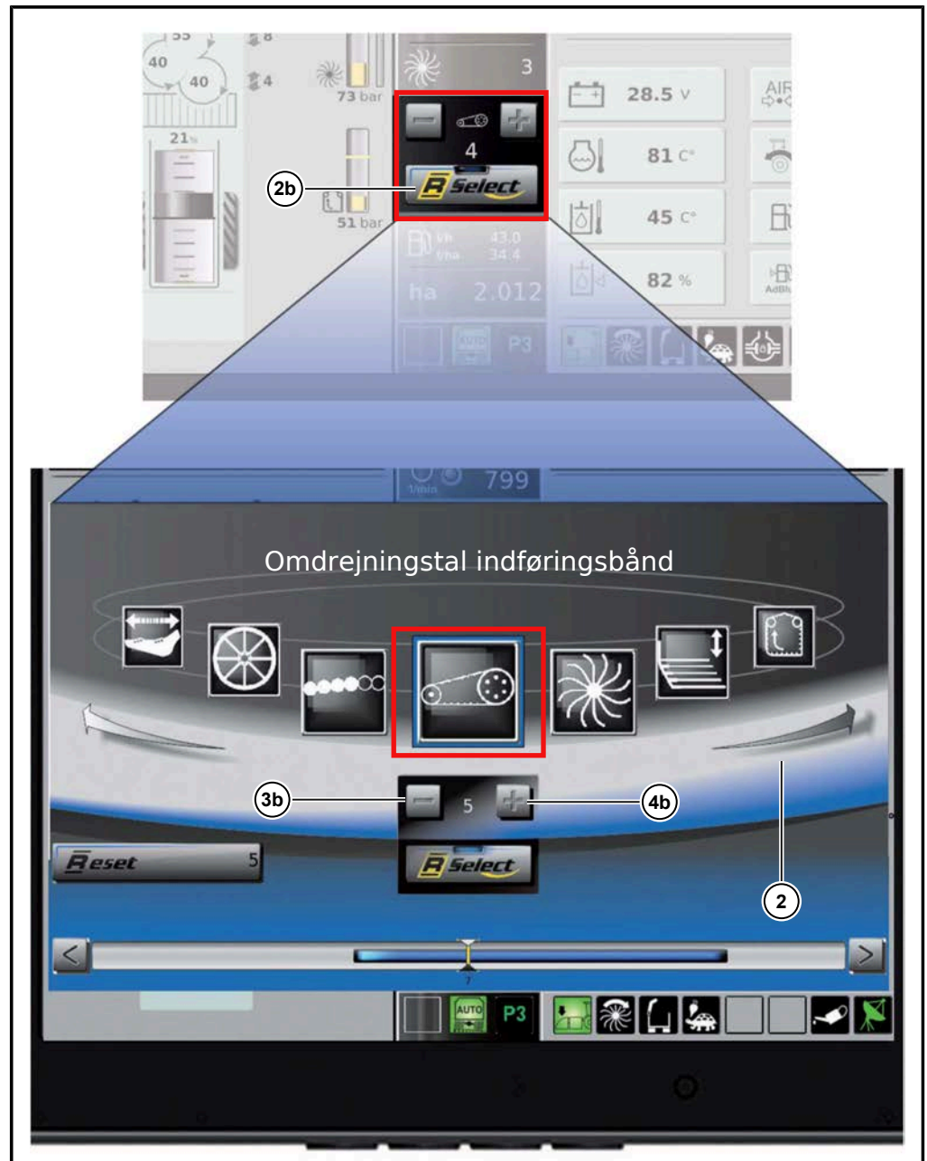
R-Select tilstand (som et eksempel er indføringsbåndets omdrejningstal valgt)
