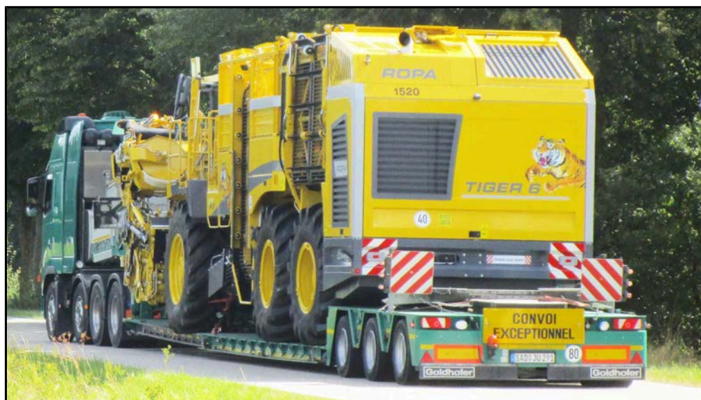
Normal blokvogn til transport på vej med minimal transport højde
