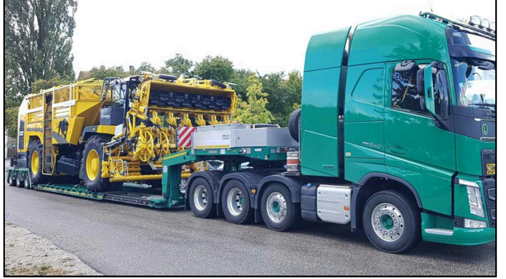
Minimum nakliye yüksekliğinde yol nakliyesi için normal römork
