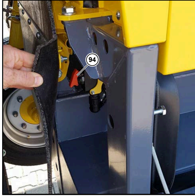
Acil şalterdeki elektrik beslemesi açık
