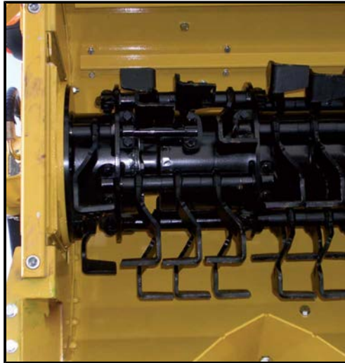
RIS'de ön hazırlayıcı bıçağı ve sıkıştırma dilleri
