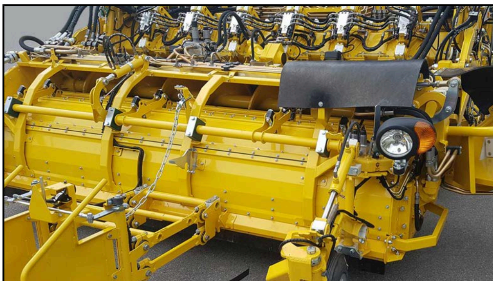
RASW-blastare, blastarlucka nere
