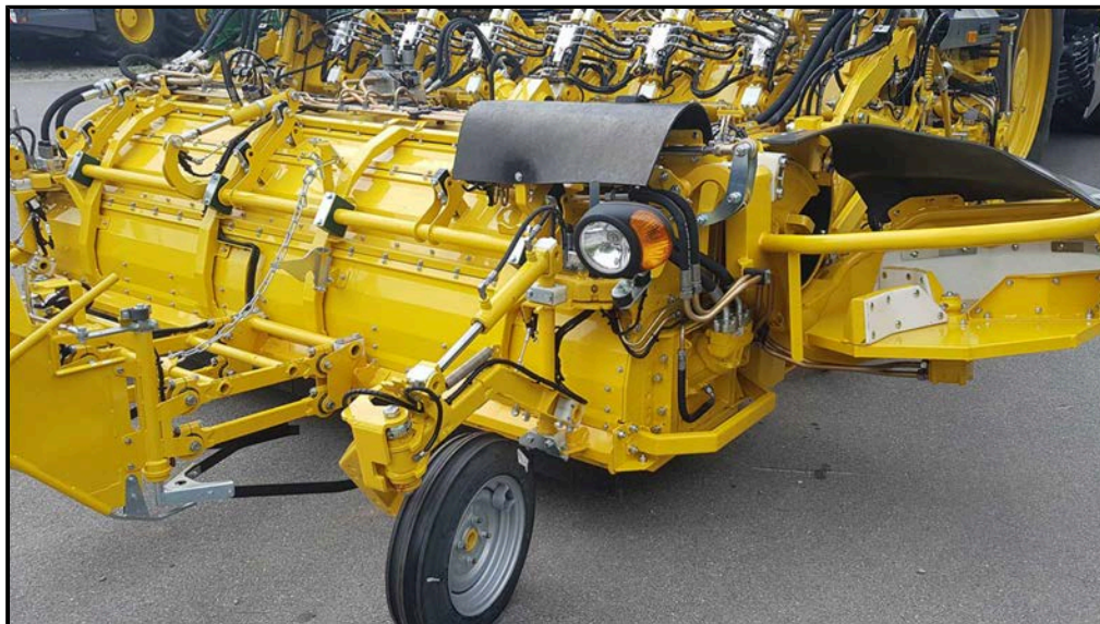
RASW-blastare, blastarlucka uppe
