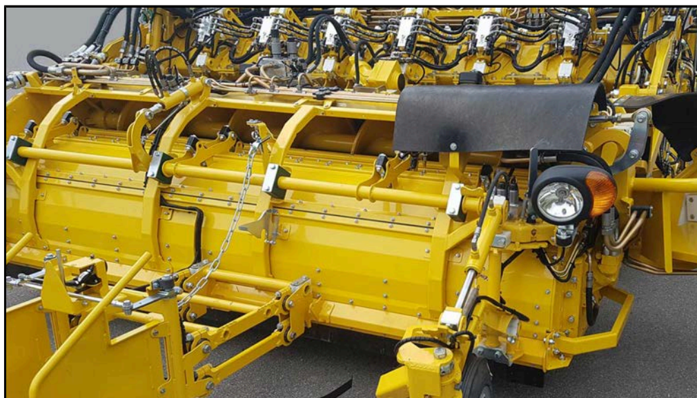
Mașină de tăiat frunze RASW, clapetă mașină de tăiat frunze la partea inferioară
