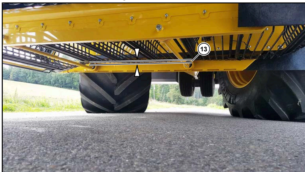
Bandă elevator tensionată corect
