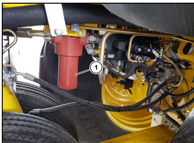
(1) Filtru de presiune instalație hidrolică de lucru
