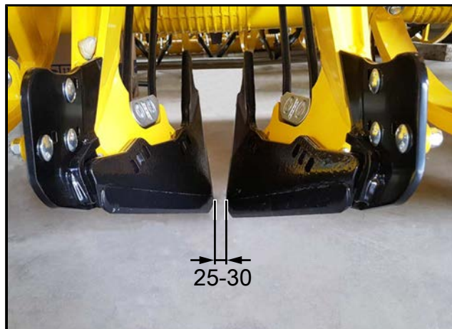
Distanță mai mică între brazde, ideal minim 25-30 mm
