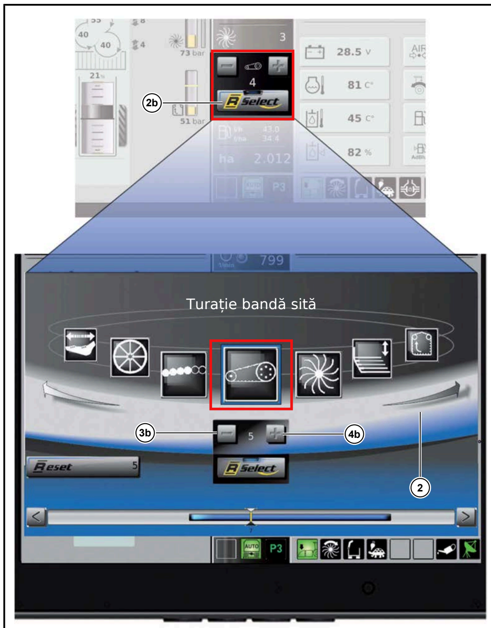
Modul R-Select (turație selectată a benzii cu sită în mod exemplificativ)
