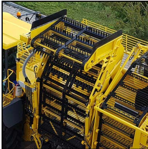
Pieșele articulate 1 și 2 ale benzii de descărcare în poziție de recoltat rădăcini
