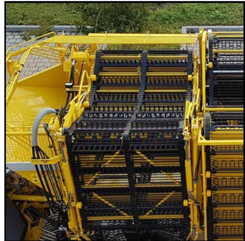
Pieșele articulate 1 și 2 ale benzii de descărcare în poziție de transport
