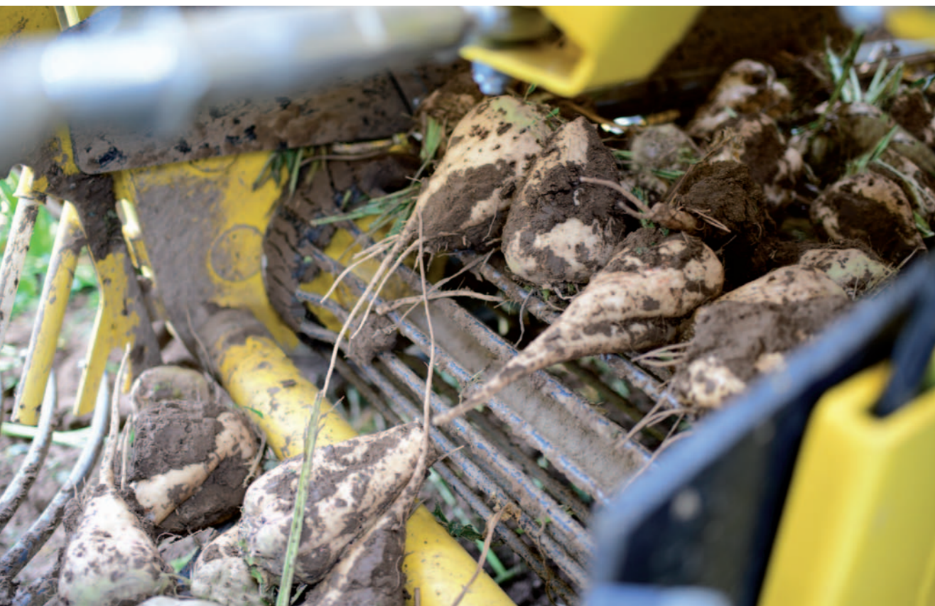
I tubi di passaggio rotanti sull'ingresso dell'elevatore impediscono il montaggio a terra
