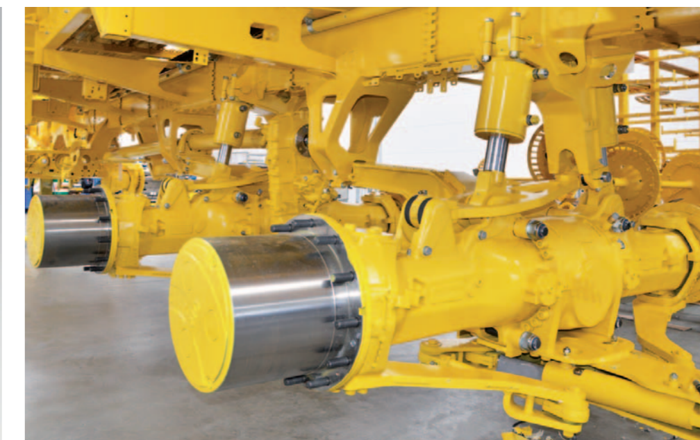
Sottocarro idraulico, compensazione pendio automatica
