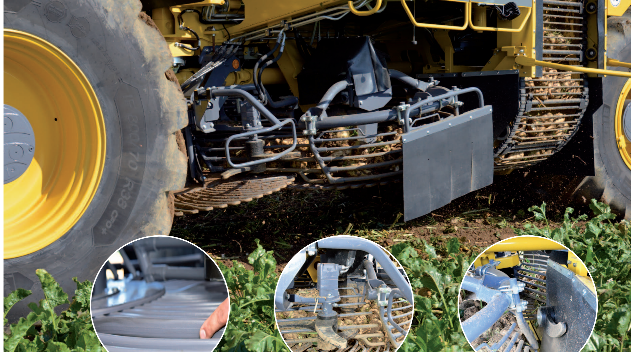
Denti delle ralle piegati
