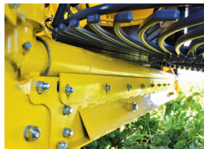
I tubi di passaggio rotanti sull'ingresso dell'elevatore impediscono il montaggio a terra
