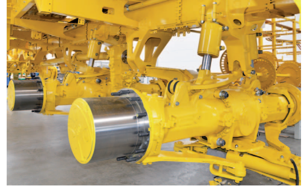
Hidrolik hareket düzenneği, otomatik eğim dengeleme
