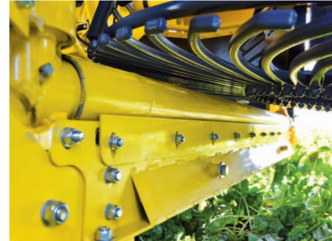
Asansör girişinde bulunan silindir borular toprak yığılmasını önler
