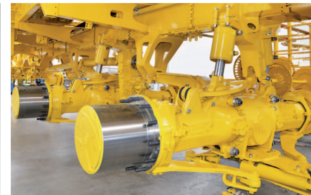
Hydrauliskt chassi, automatisk lutningskompensation
