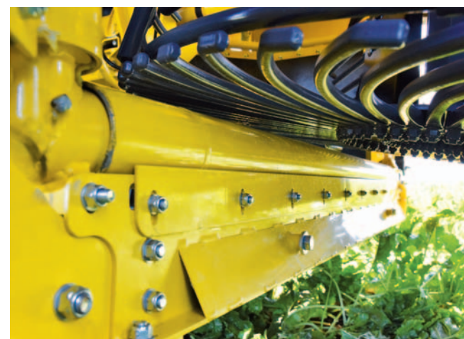
Roterande övergångsrör vid elevatorinloppet förhindrar jordansamlingar
