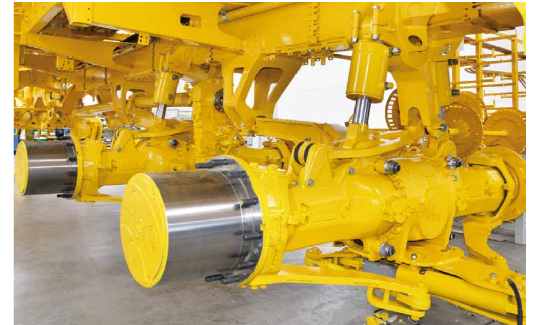
液压行走机构，自动斜坡平衡
