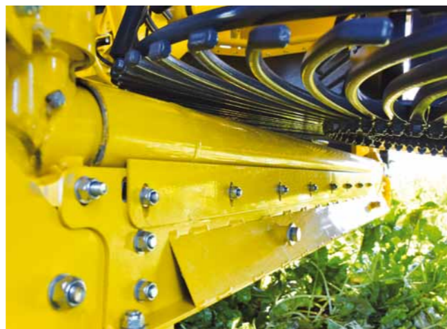
环形升降带入口处的旋转过渡管可防止积土
