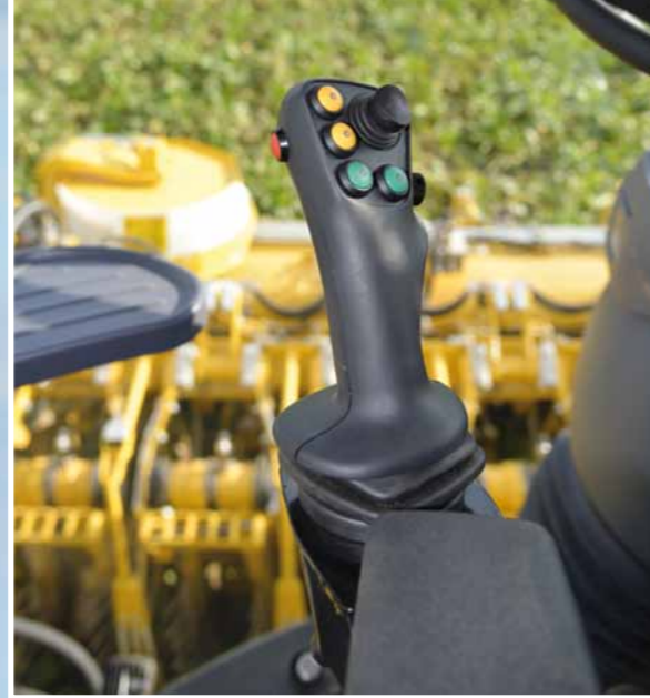
左扶手上用于灵敏控制 储料仓清空的操作元件
