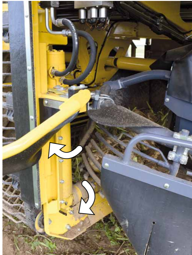
环形升降带入口处的旋转过渡管可防止积土
