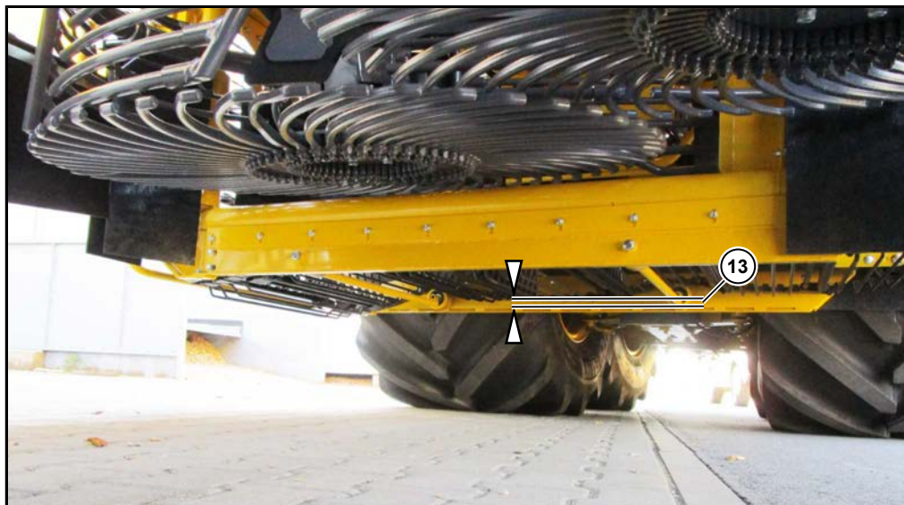
Nastro dell'elevatore correttamente teso
