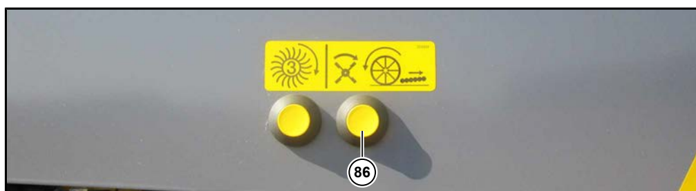
Interruttore sul parafango destro
