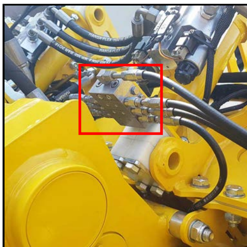
Distributore principale sulla trasmissione eccentrica del vomere vibrante
