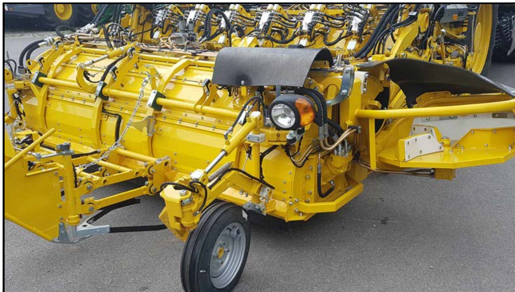
RASW-blastare, blastarlucka uppe
