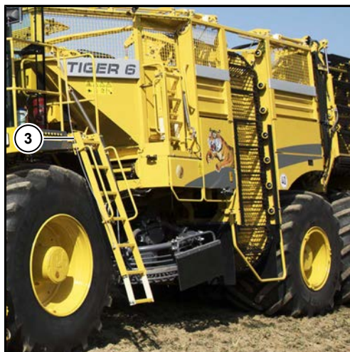
Stege till förarhytten i läge vägkörning resp. upptagning
