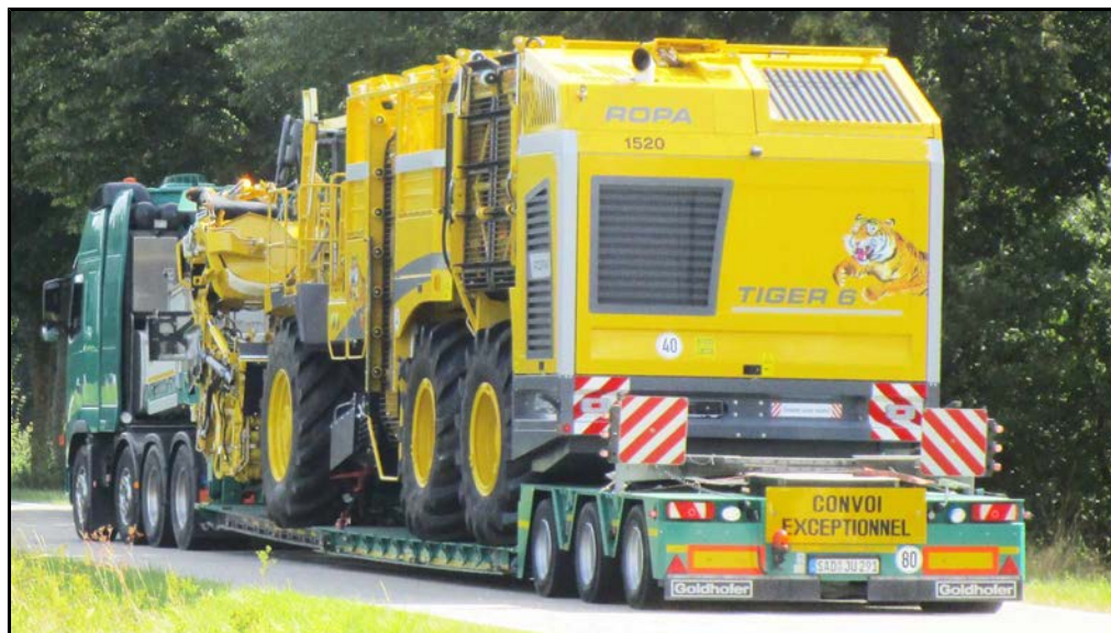
Korrekt utrustad trailer för vägtransport med minimal transporthöjd
