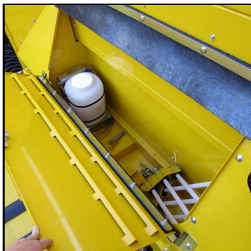
Förvaringsfack i tanken
