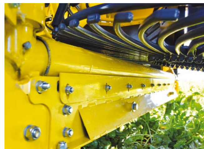
Вращающиеся переходные трубки на входе элеватора предотвращают накопление почвы
