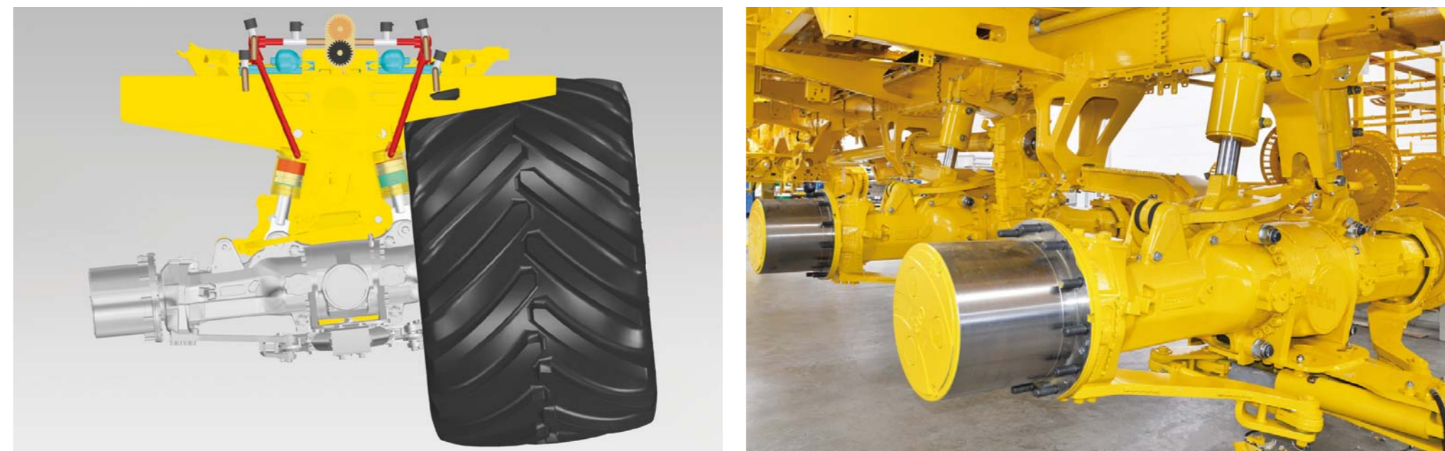
Гидравлическая система шасси, автоматическое выравнивание на склоне
