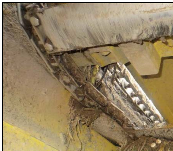
Este necesară retensionarea!
