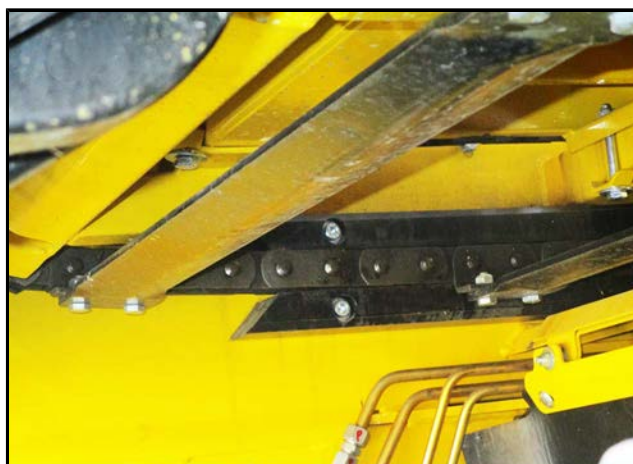
Corecți tensionarea lanțului
