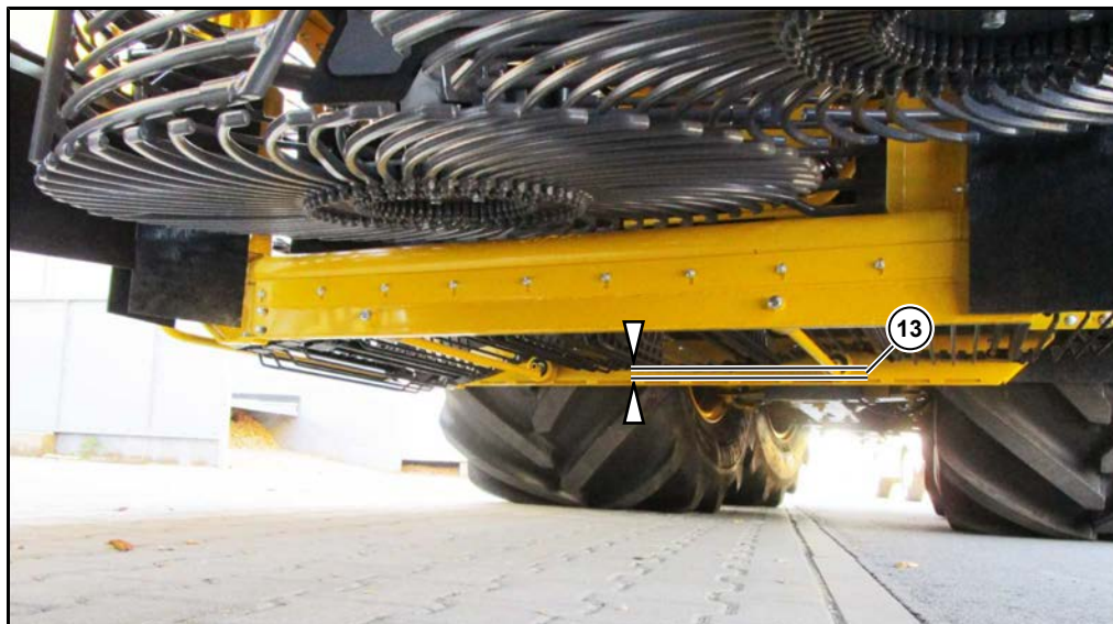
Bandă elevator tensionată corect
