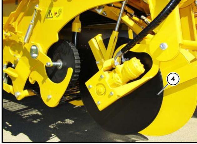
(4) Hidrolik tahrikle çalışan disk pulluk bıçaklı set toplayıcı
