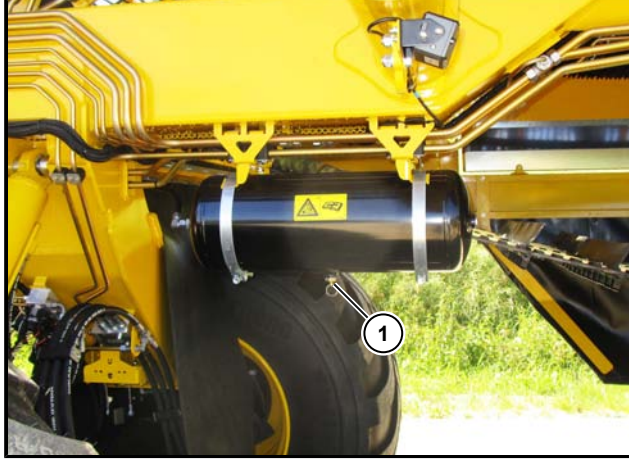
(1) Tahliye valfli basınçlı hava deposu
