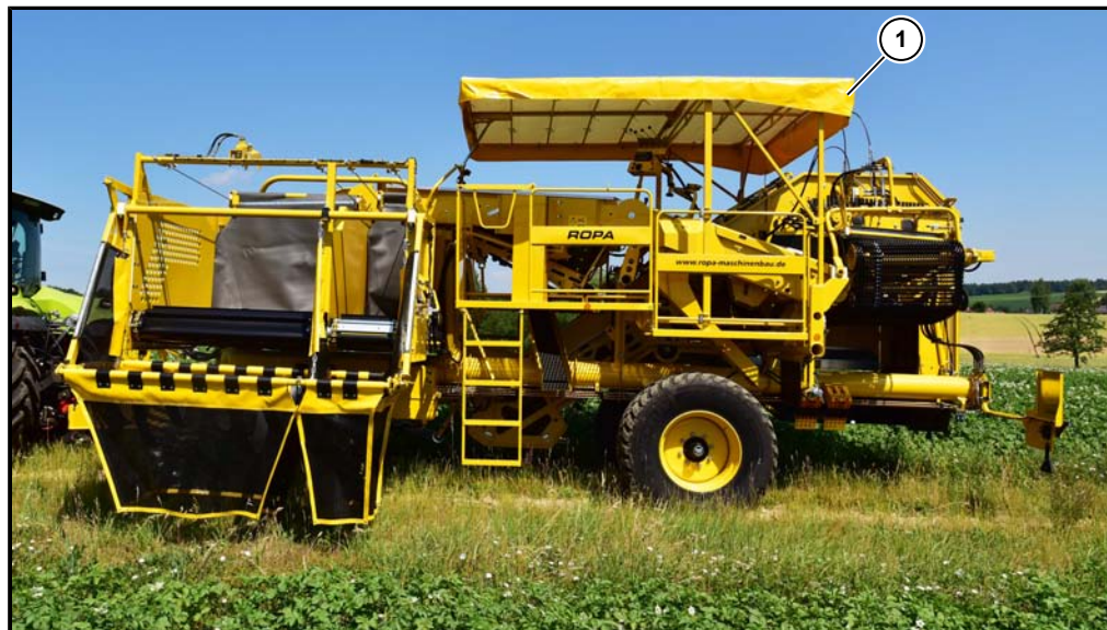
(1) Krov za zaštitu od sunca
