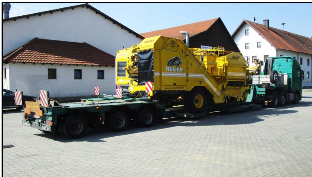
Propisan transporter sa niskim ramom za ulični transport sa minimalnom transportnom visinom
