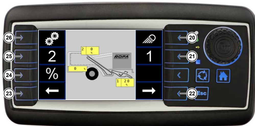
Prebiralna miza, posamezna nastavitve avtomatike presejalne verige
