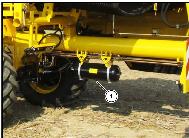
(1) Izpustni ventil/ventil za odvodnjavanje
