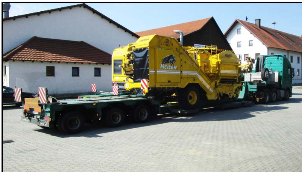
Običajni nizki priklopnik za cestni transport z minimalno transportno višino
