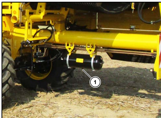
(1) Posoda s stisnjenim zrakom z izpustnim ventilom
