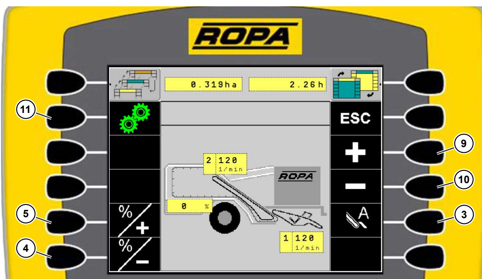
Sinhrona prestavitev presejalnih verig
