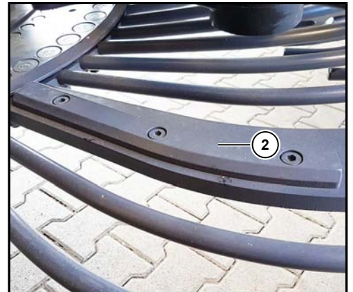
(2) 第 1 星状过滤网上的拨片（仅在制造年限 2017 年之前）
